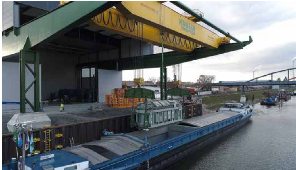
Schwergutlogistik par excellence: Großmotoren werden teilmontiert per Bahn angeliefert, im Schwergutzentrum montiert und verpackt. Danach geht es mit dem Rheinshuttle exportbereit und terminogenau zu den Seehäfen.
