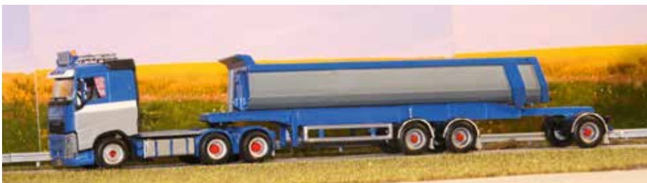
Der Kippauflieger entstand nach schwedischem Vorbild. Die letzte Achse kann zwecks Nutzlast-erhöhung ausgezogen werden.
