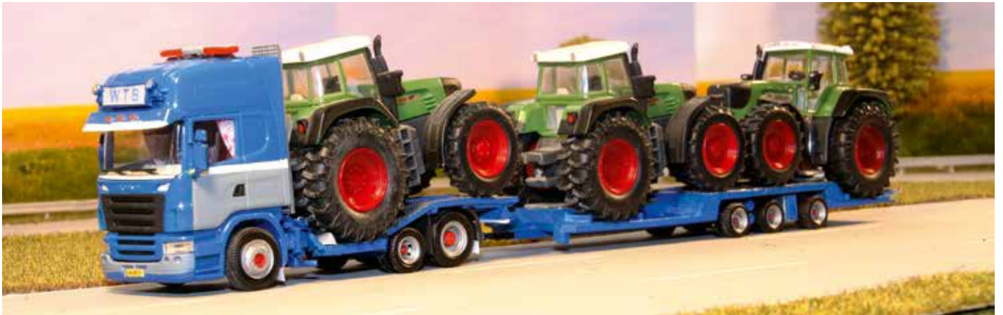
Der Scania-Sattelzug mit großen Radmulden für den Transport von Traktoren. Bei Bedarf können die Radmulden abgedeckt werden.
