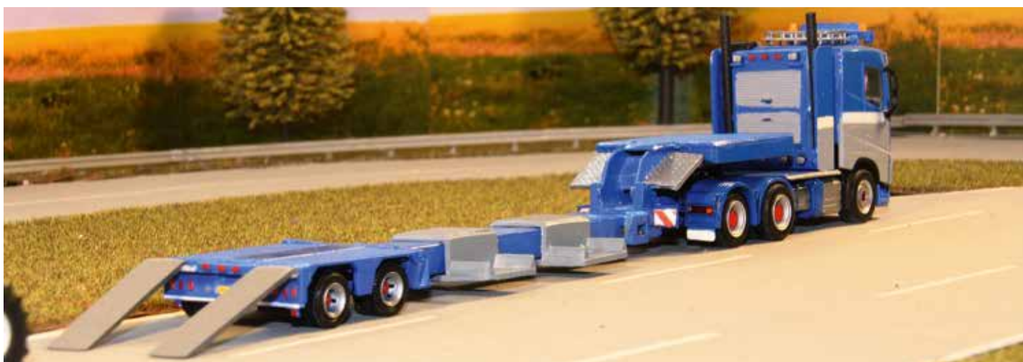
Der Volvo-Zugmaschine mit Flachdach wurde ein verkleideter Werkzeugschrank aufgebaut. Der Auflieger ist, wie beim Original, teleskopierbar. Der Schwannenhals ist abnehmbar und die Radmulden sind zu verschieben. So lassen sich die verschiedensten Landwirtschaftsmaschinen transportieren.
