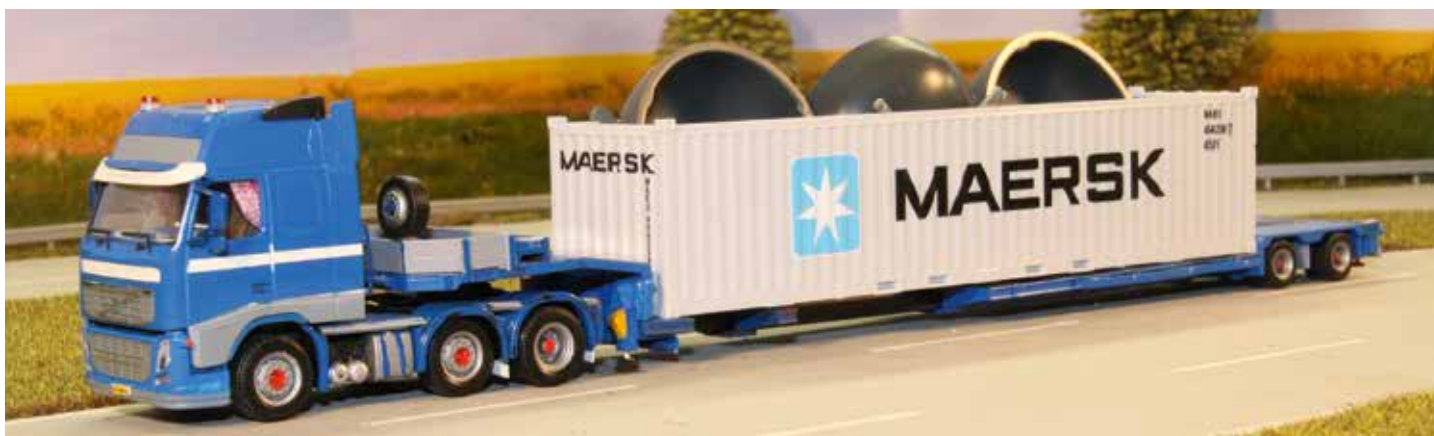
Diese 3-achsige Volvo-Zugmaschine mit 2-Achs-Auflieger wurden zum Transport verschiedener Ladungen gebaut. Der Auflieger ist ein Herpa-Tieflader, der zum Tiefbettauflieger umgebaut wurde. Der Auflieger ist teleskopierbar und der Schwannenhals abnehmbar. Ähnlich wie beim Original, daher können auch Container mit „Überhöhe“ gefahren werden.
