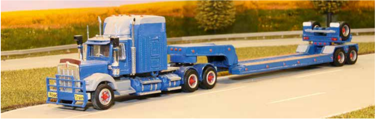
Hier wurde die Zugmaschine als „Road Train“-Zugmaschine ausgeführt, hat aber in diesem Fall einen Tieflader „am Haken“, der die Besonderheit hat, dass die letzte Achse bei Leerfahrten nach oben gekippt wird.
