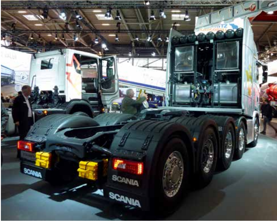
5-achsige Schwerlastzugmaschinen könnten Konjunktur haben, denn die Sattelast von 4-Achsern wird für den Transport der neuen Mega-Rotorblättern kaum ausreichen. STM-Bild
