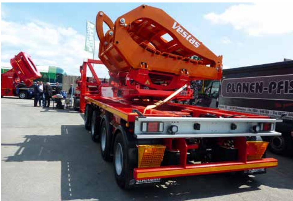
Nachläuferlösung für den Transport von Rotorblättern von Scheuerle.
