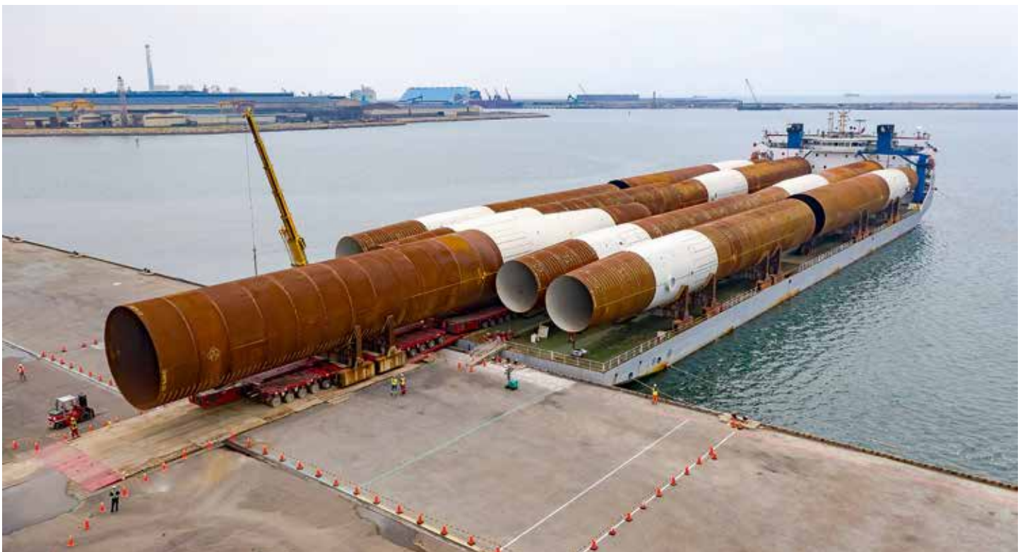
ALE transportiert Monopiles für einen offshore-Windpark in Asien. Der offshore Windenergieausbau geht aber auch in Deutschland gut voran und es scheint sehr wahrscheinlich, dass die Ausbauziele für 2020 und für 2030 vorzeitig erreicht werden.
