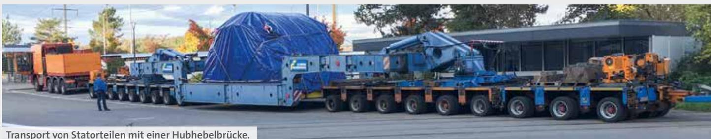
Transport von Statorteilen mit einer Hubhebelbrücke.
