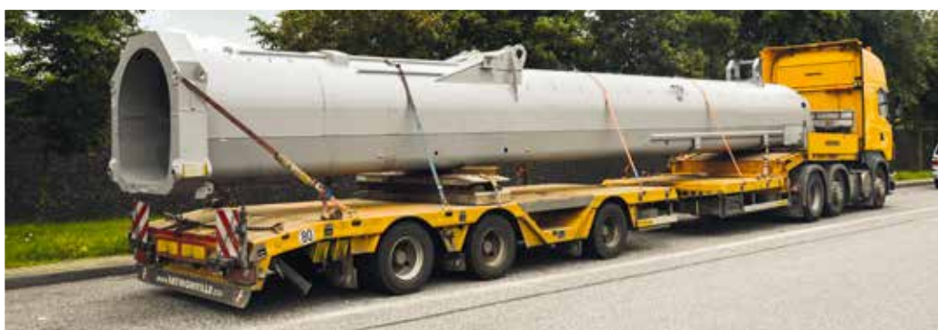
Die Radmulden dieses Aufliegers werden bei diesem Transport eines Teleskopauslegerschusses natürlich nicht benötigt.
