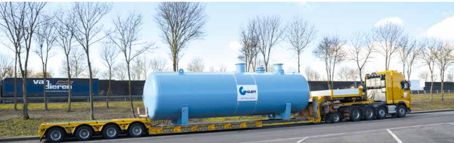
Mit Swing-Dolly ist dieser Transport im Prinzip im 2-Anhängerbetrieb unterwegs.
