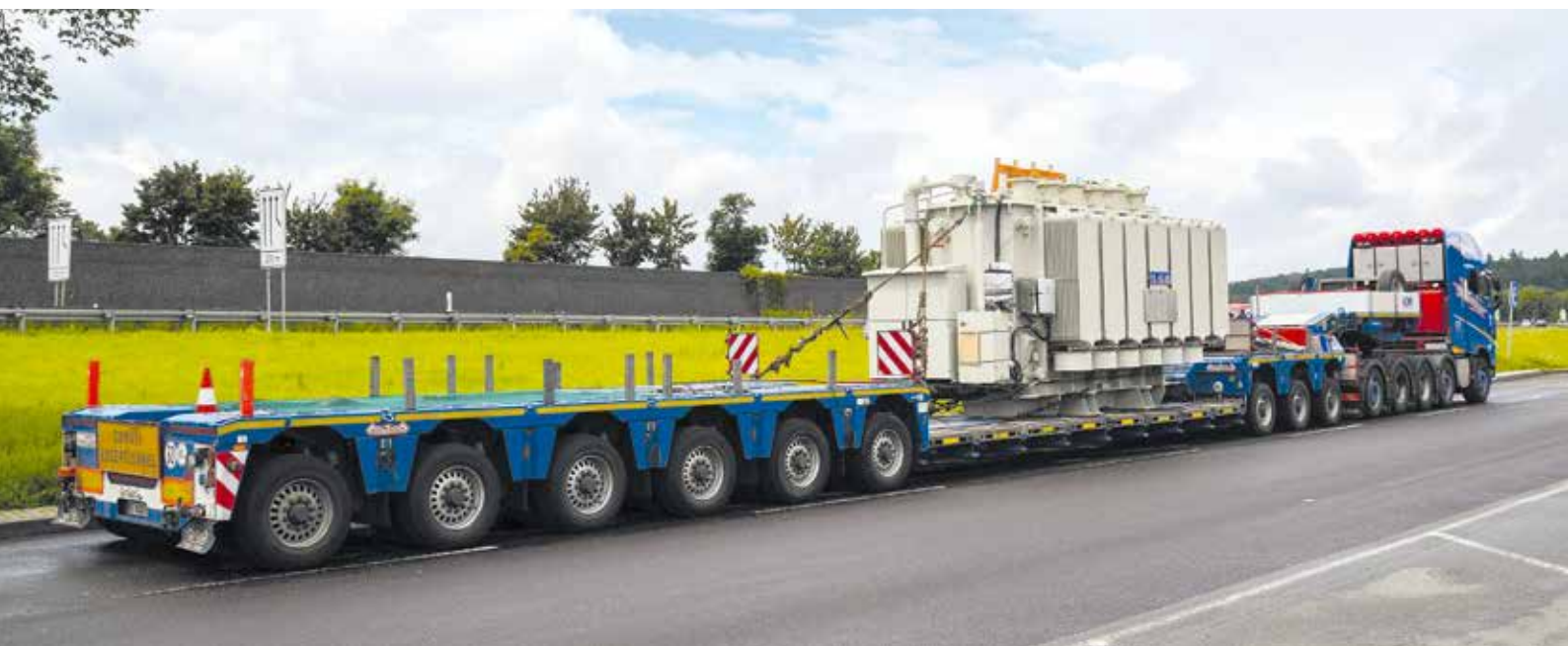
4-achsige Zugmaschine, 3-achsiges Dolly-Fahrwerk, 6-achsiges Hinterachsfahrwerk: Das lässt auf reichlich Transportgewicht schließen.
