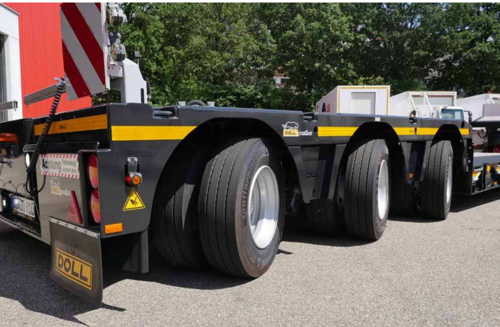
Flexibel und wendig: Das hydraulisch gefederte und gelenkte panther-Fahrwerk bietet 315 mm Gesamthub und bis 55 Grad Lenkeinschlag.
