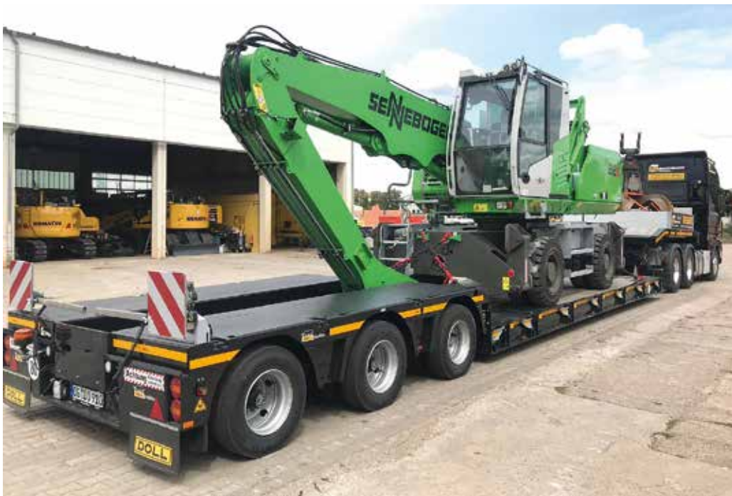
Schnell und einfach verladen: Doll panther Tiefbett mit knapp 3,30 m hoher Umschlagmaschine.
