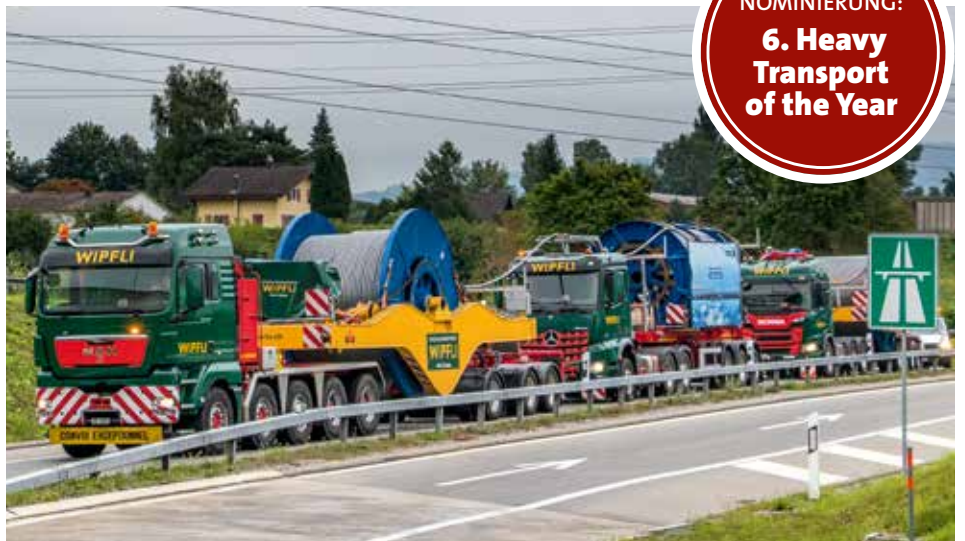
Auf drei Fahrzeugen transportiert Wipfli das Seil für die neue 3S-Bahn.
