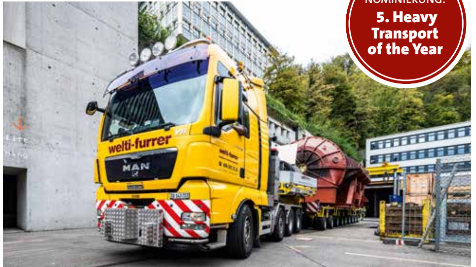
Auf 9-achsigen Plattformwagen erfolgt der innerbetriebliche Teil des Transports.
