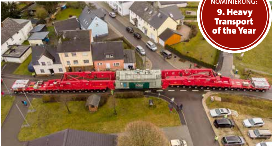
Mehrfach wird der Transport – der hier gerade Dichtelbach passiert – umgebaut. Zum Teil sind fünf Schwerlastzugmaschinen gleichzeitig im Einsatz.
