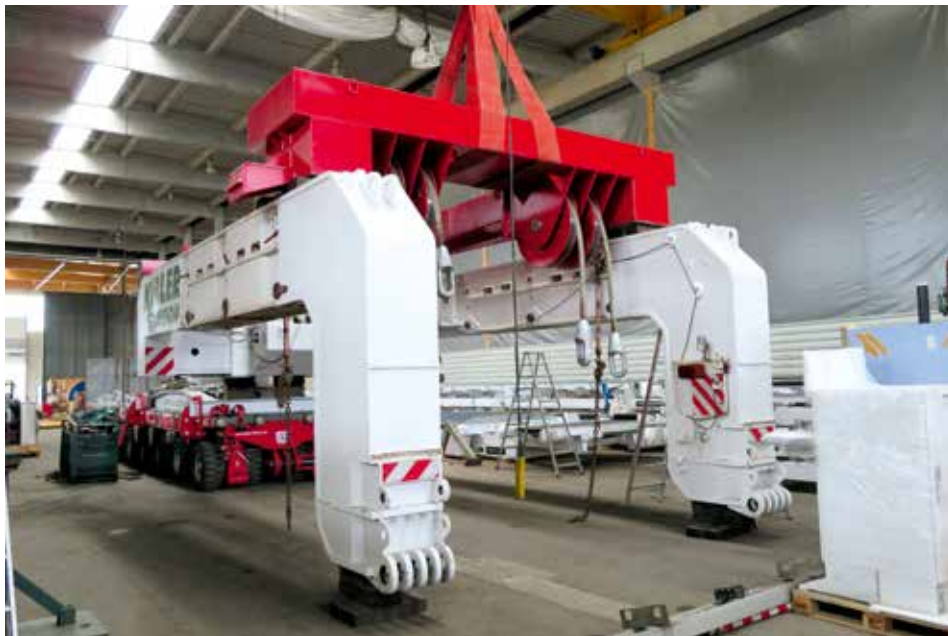
Probemontage der von Riga-Mainz entwickelten und eigens gefertigten Hebekonstruktion auf der Hubhebelbrücke in den Hallen der Kübler Spedition.
