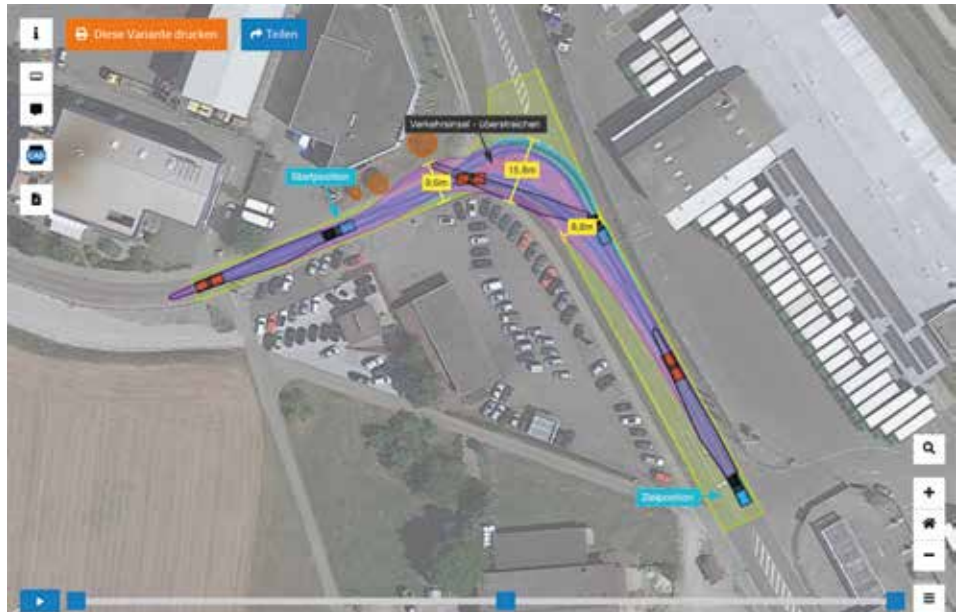
Schleppkurven-Video einer Nachläuferkombi mit Rotorblatt in HeavyGoods.net. Die Schleppkurve kann über die beiden Buttons oben als Video verschickt oder als Prüfbericht ausgedruckt werden – inkl. eingezeichneter Maßlinien und Hinweisboxen.
