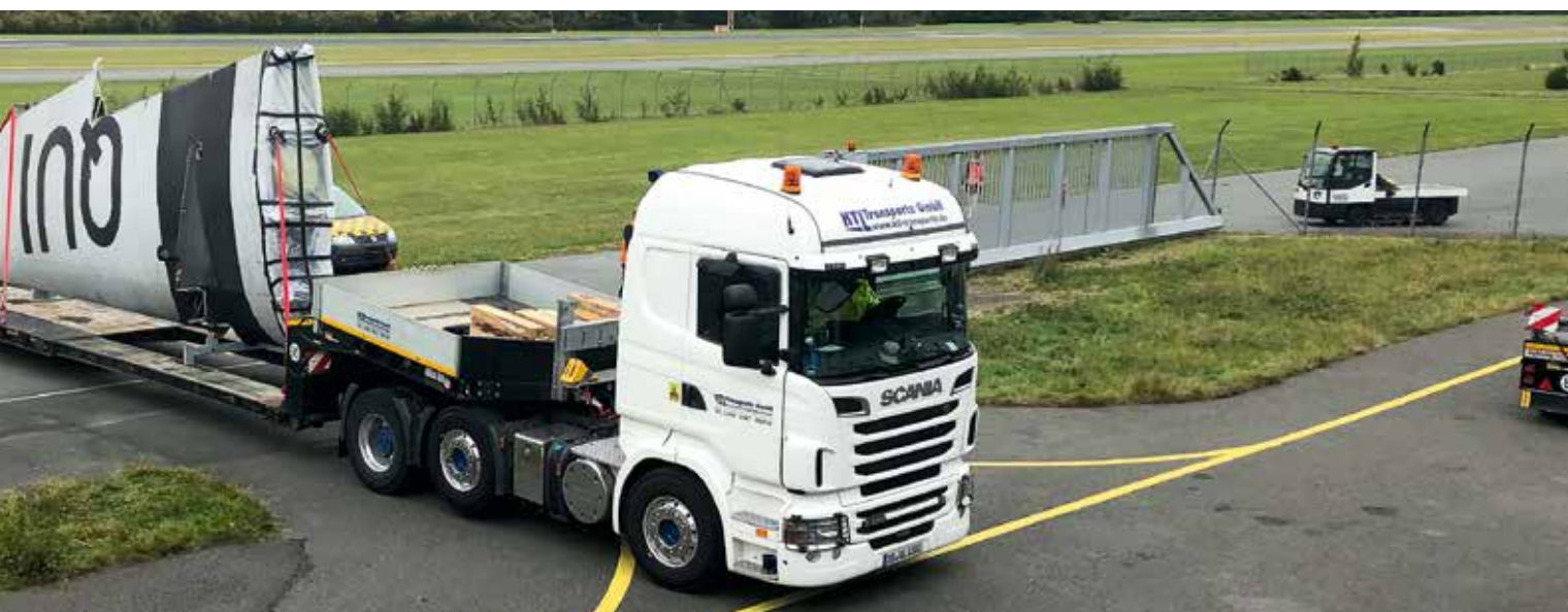
Die 13 m langen Tragflügel wurden jeweils auf einem eigenen Tieflader transportiert.
