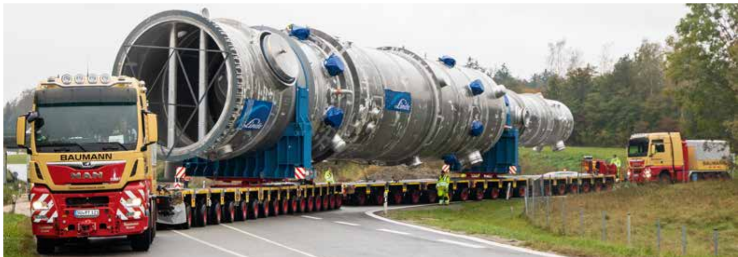
Bis zu fünf Zugmaschinen kamen zum Einsatz.
