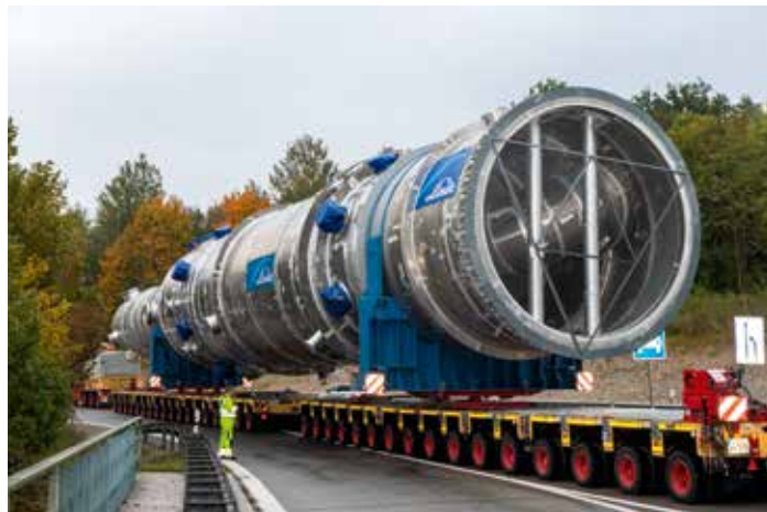
Die THP/SL-L Achslinien von Goldhofer bieten eine Achslinienlast von 26 t bei einer Geschwindigkeit von 20 km/h.
