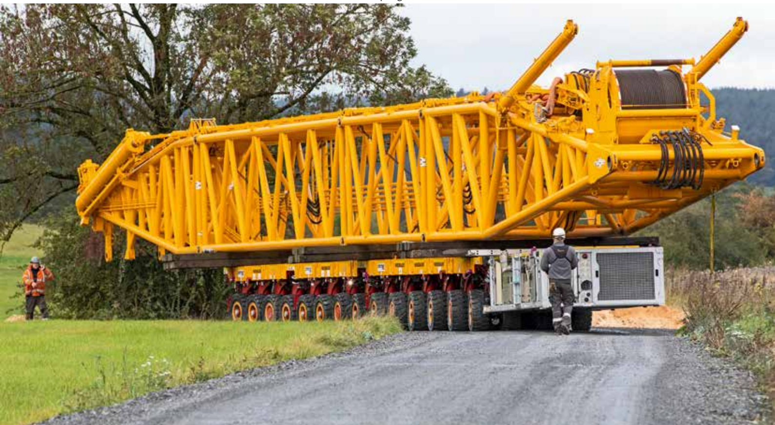
Die 14-Achs-Ausführung des Cometto SPMT hatte den 42 m langen Derrickmast mit einem Eigengewicht von 60 t geladen.
