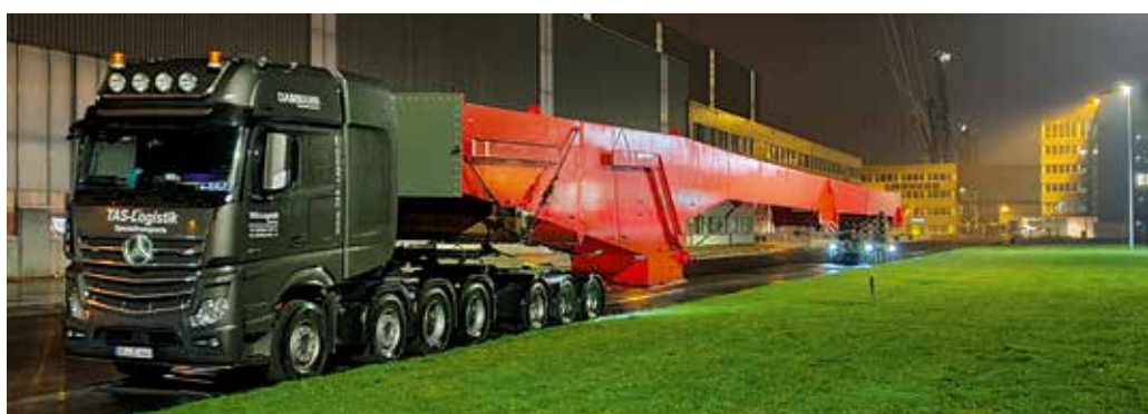
Beim längsten Gespann ragt die Ladung hinten 4,5 Meter über den Nachläufer.
