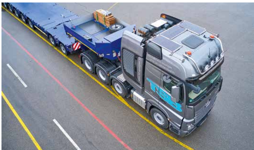
Die Vogelperspektive zeigt es: auf dem Dach des SLT findet sich eine Photovoltaik-Anlage.
