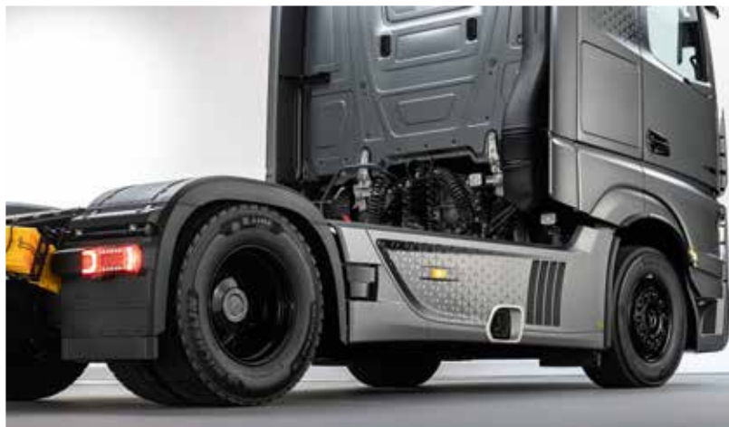
Die Hinterachskappen beziehungsweise Hinterachstöpfe sind ebenfalls in Edelstahl mit Radmutterstutzkappen ausgeführt
