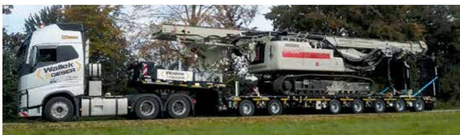
Transport eines Bohrgeräts mit 68 Tonnen Eigengewicht.
