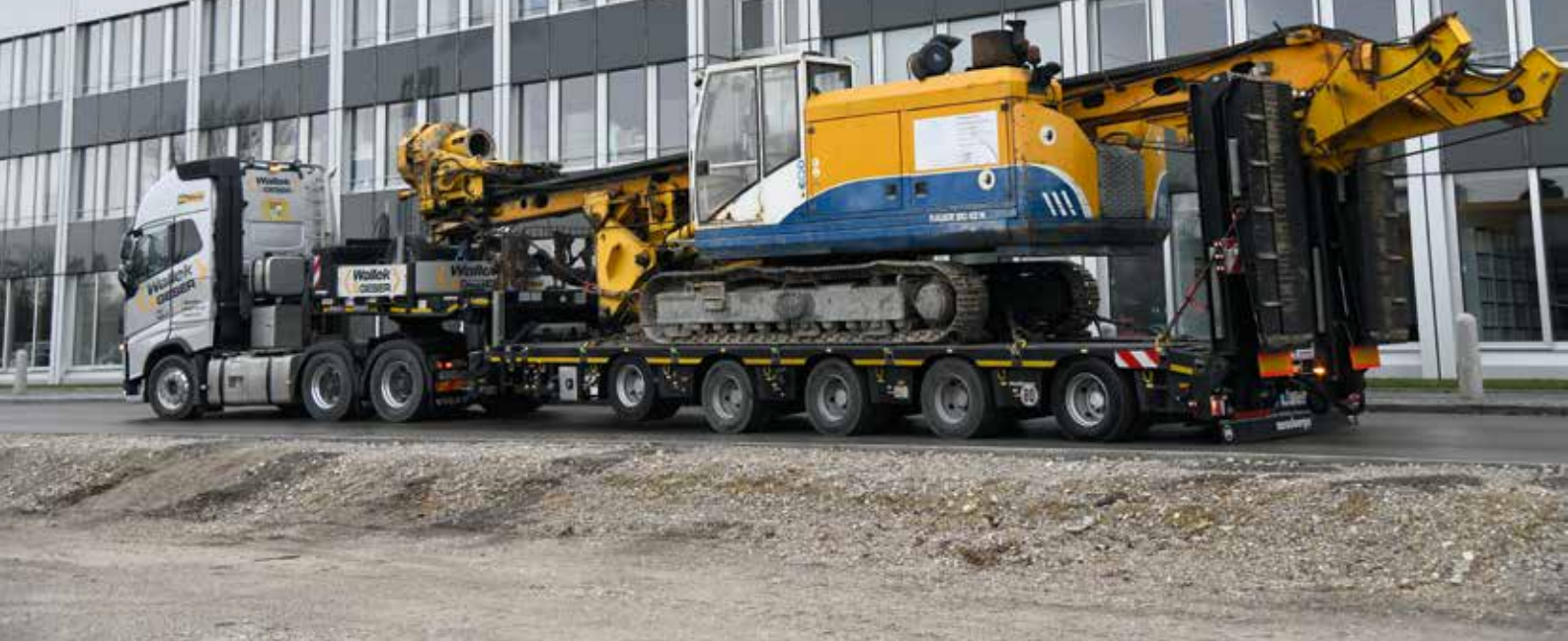
Transport eines Bohrgeräts mit 45 Tonnen Eigengewicht.
