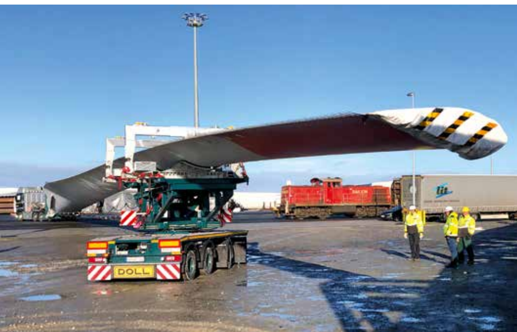
Mit 55 Grad Lenkeinschlag und 85 Grad Schwenkbereich des Spezialschemels bietet der Nachläufer optimale Rangiereigenschaften.
