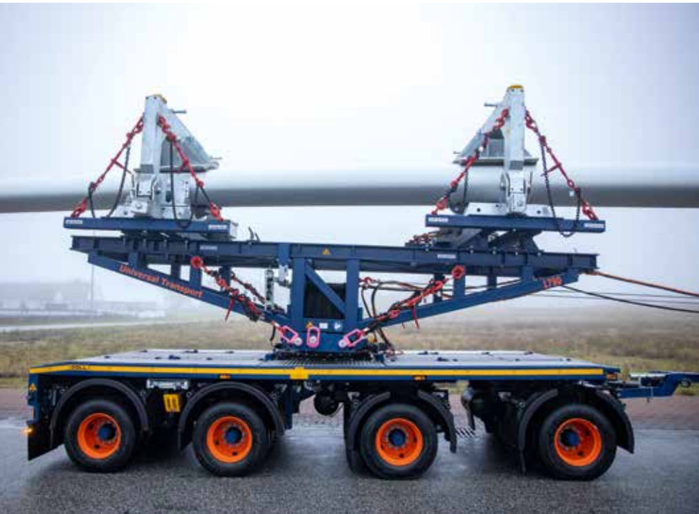
800 Millimeter Gesamthub eröffnen am Hubadapter weitere Möglichkeiten: Sei es tief geduckt unter Brücken hindurch oder hochgefahren über Leitplanken hinweg.
