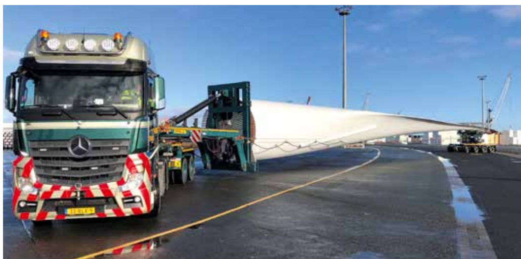
Probeverladung im Hafen Brake: Bolk Transport schulterte mit der neuen DOLL-Kombination Mitte Januar das erste 65-Meter-Blatt.
