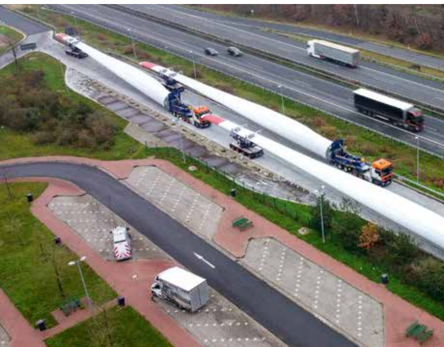
Mit 65 Meter langen Rotorblättern ergeben sich für die Fahrer von Universal Transport rund 77 Meter Gesamtzuglänge.
