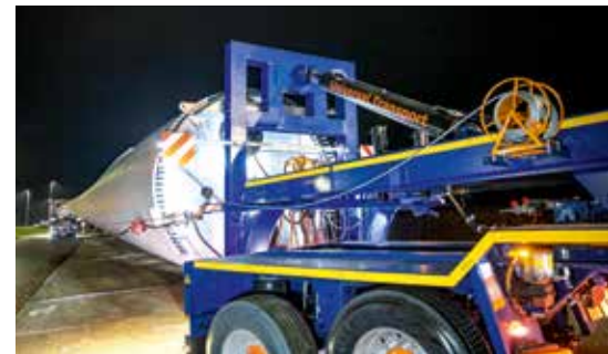
800 Millimeter Gesamthub eröffnen am Hubadapter weitere Möglichkeiten: Sei es tief geduckt unter Brücken hindurch oder hochgefahren über Leitplanken hinweg.
