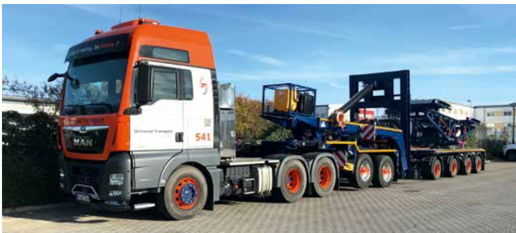
Bei Leerfahrt bilden Nachläufer, Dolly mit Hubadapter und Zugmaschine eine kompakte Einheit.
