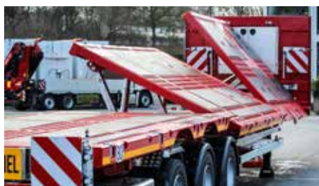
Ein Elektro-Hydraulikaggregat bringt die Ladefläche in die richtige Position.
