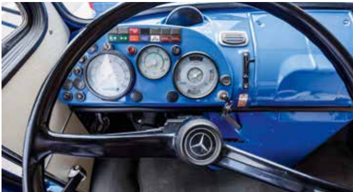
Ins Auge sticht die blau lackierte Brüstung des zum Langesentransporter umgebauten Kurzhaubers Mercedes-Benz L 2624/6x4 aus dem Jahr 1969. Das Fahrzeug bestach durch seine ebenso einfache wie robuste Technik, die auch in der bescheidenen Instrumentierung des Cockpits seinen Ausdruck findet.
