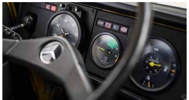
Einen für seine Zeit modernen Arbeitsplatz mit ergonomisch optimiertem Lenkrad und klarer Aufteilung von Schaltern und Anzeigen bietet dieser leichte Kipper Mercedes-Benz LPK 813 von 1985.
