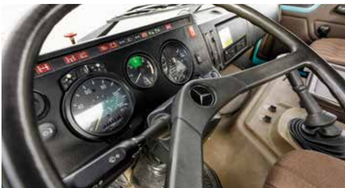
In den Fahrerhäusern der sogenannten Neuen Generation (NG) prägten, der Zeit gemäß, moderne Kunststoffe und eine übersichtliche Sachlichkeit den Fahrerarbeitsplatz, hier zu sehen in einem Mercedes-Benz AK 1936 aus dem Jahr 1988.
