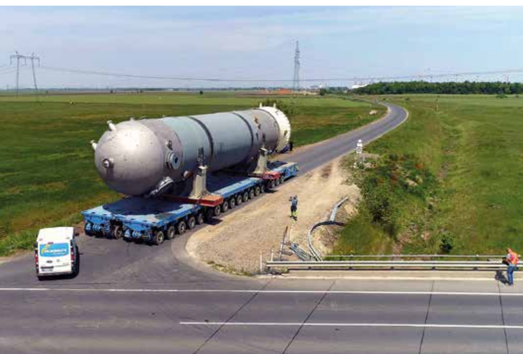
Im „Linienverkehr“ wurden die etwa 100 Oversized-Cargos vom Umschlagplatz zur Baustelle gebracht.
