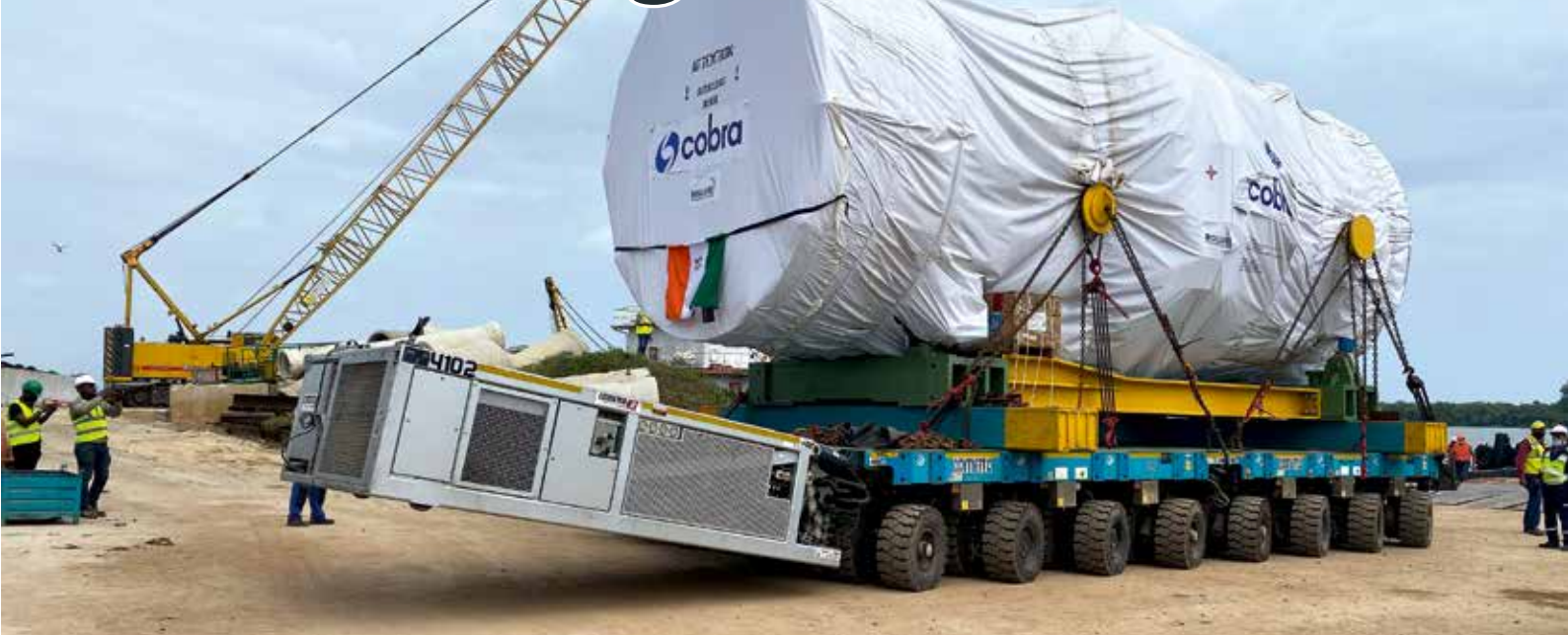
Marine Maroc beförderte eine 361-Tonnen-Turbine und einen 295-Tonnen-Generator in der SPMT-Konfiguration.
