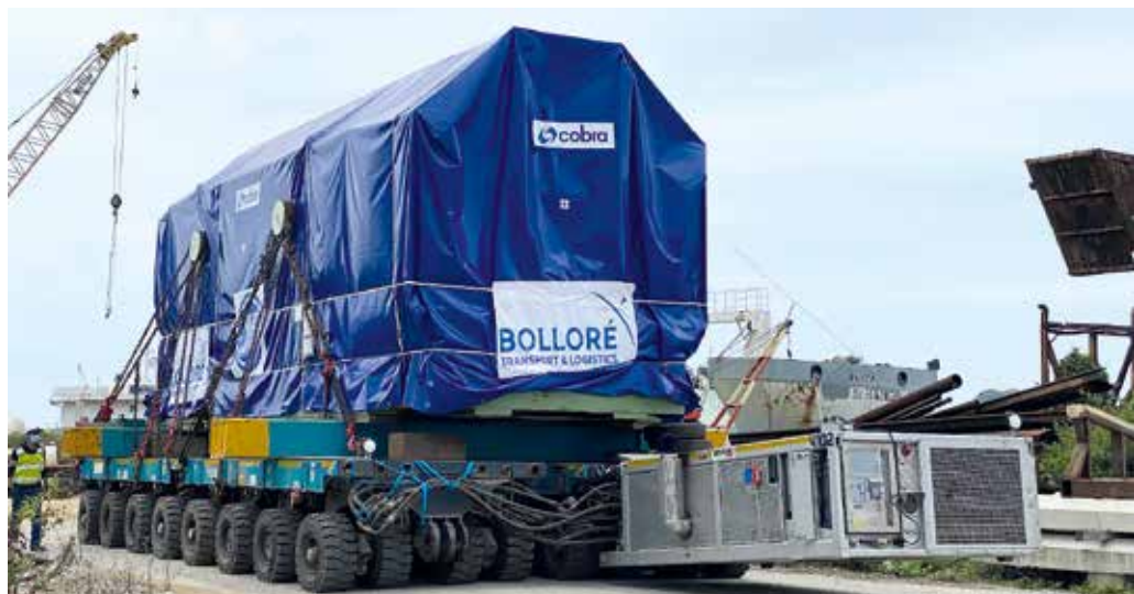
Selbst in engen Bereichen und auf abfallenden Streckenabschnitten ist der selbstfahrende modulare Transporter SPMT einfach zu handhaben.
