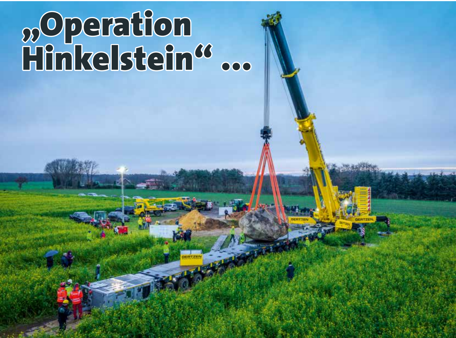
Der „Hinkelstein“ von Hüven wird mithilfe eines Krans geborgen und auf den Cometto SPMT Selbstfahrer gehoben.
