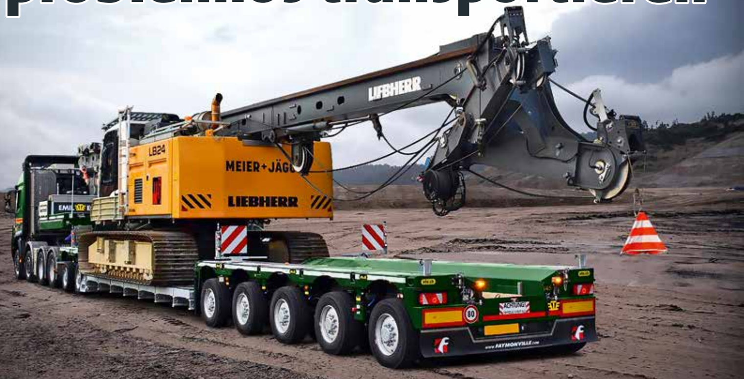
Ein Tiefbettauflieger der Produktserie GigaMAX transportiert ein Bohrgerät auf Raupenfahrgestell.
