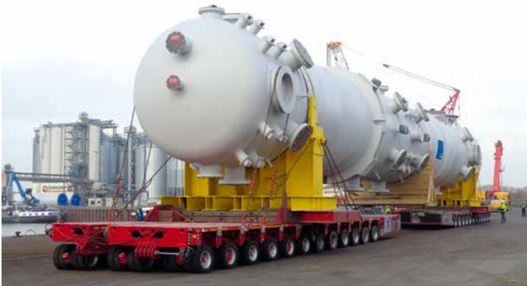
658 t und 46,33 m Länge des Wärmetauschers verteilt auf zwei Goldhofer Schwerlastmodule mit jeweils 12 Achslinien.
