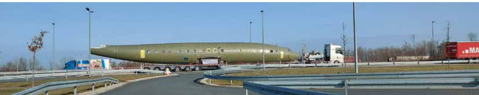
Zum Einsatz kam dabei eine Nooteboom Teletrailer mit sechs Achsen.
