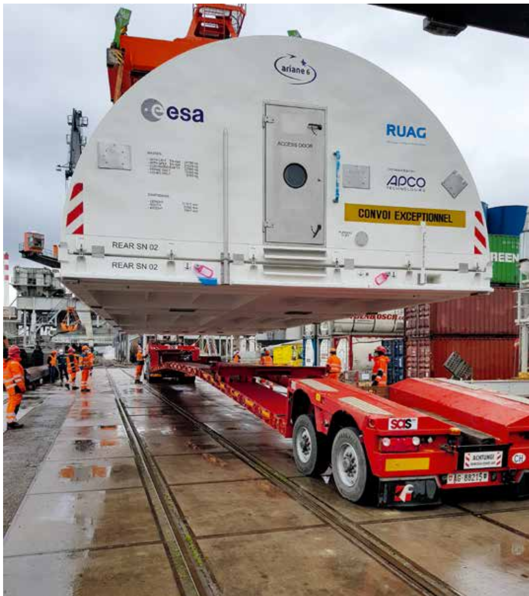
Der Faymonville MegaMAX kurz vor der Aufnahme des 24 Tonnen Stahlcontainers.
