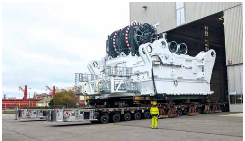
Ein 1.200 Tonnen schweres Drehbühnen-Unterteil eines Offshore-Schiffskrans der Firma Liebherr wird über das Werksgelände transportiert.
