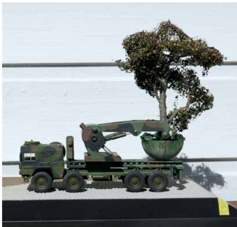
Auch beim zweiten Modell sind Zwischenrahmen und Lastaufnahmemittel im 3D-Druckverfahren entstanden.
