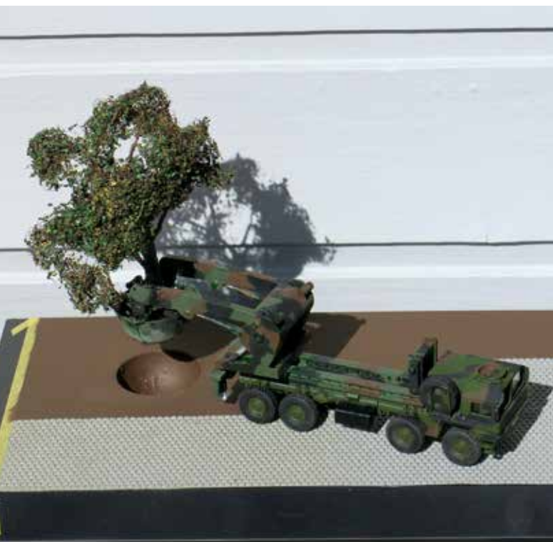
Auch beim zweiten Modell sind Zwischenrahmen und Lastaufnahmemittel im 3D-Druckverfahren entstanden.
