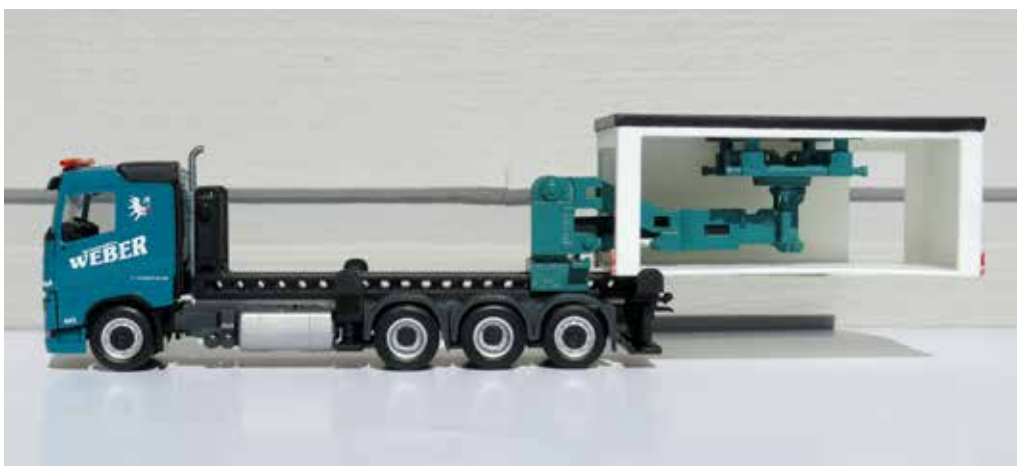
Während die Weber-Zugmaschine ein Herpa-Modell ist, sind Zwischenrahmen, zweiteiliger Absetzarm sowie Garagen im 3D-Druckverfahren entstanden.
