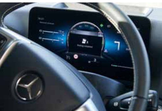
Der neue Mercedes-Benz Active Sideguard Assist erkennt Fußgänger oder Radfahrer und führt Notfallbremsungen aus.
