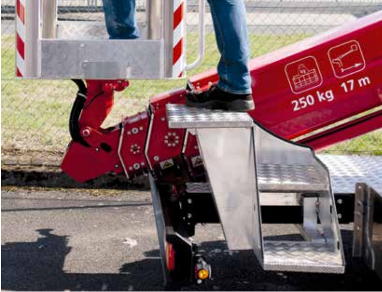
Die Treppe der Ecoline 230 ermöglicht einen aufrechten Einstieg in den Arbeitskorb.
