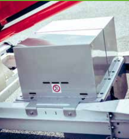
Das „Herz“ der Ecoline 180 & 160 Hybrid: Der Lithium-Ionen-Akkumulator (90 Ah, 48 V) bekannt aus der Bluelift-Produktreihe.
