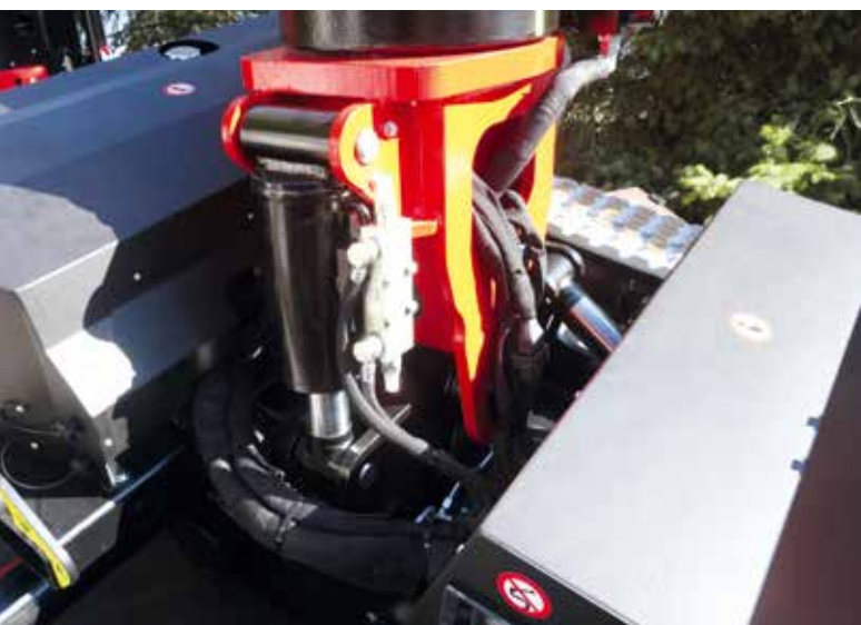
Dank des neuen automatischen Nivelliersystems stellen Längs- und Querneigungen für die JIBBI 1250 EVO kein Problem dar.
