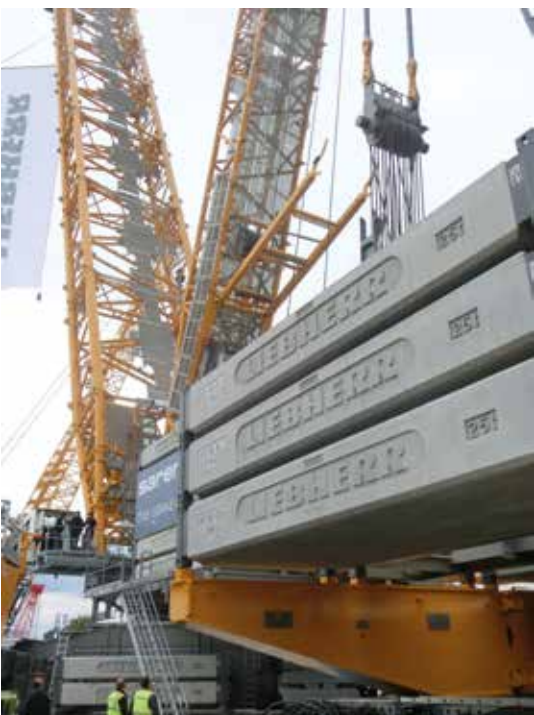
Zu besichtigen, die LR12500 mit dem 7,5 m breiten High Performance Boom.
