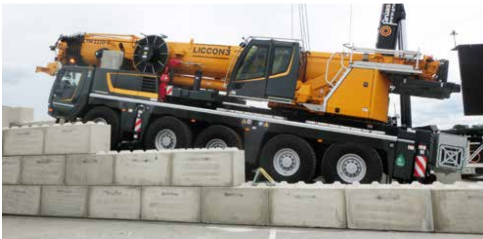
Der LTM 1110-5.2 im Getriebe-Stresstest bei 20 % Steigung.
