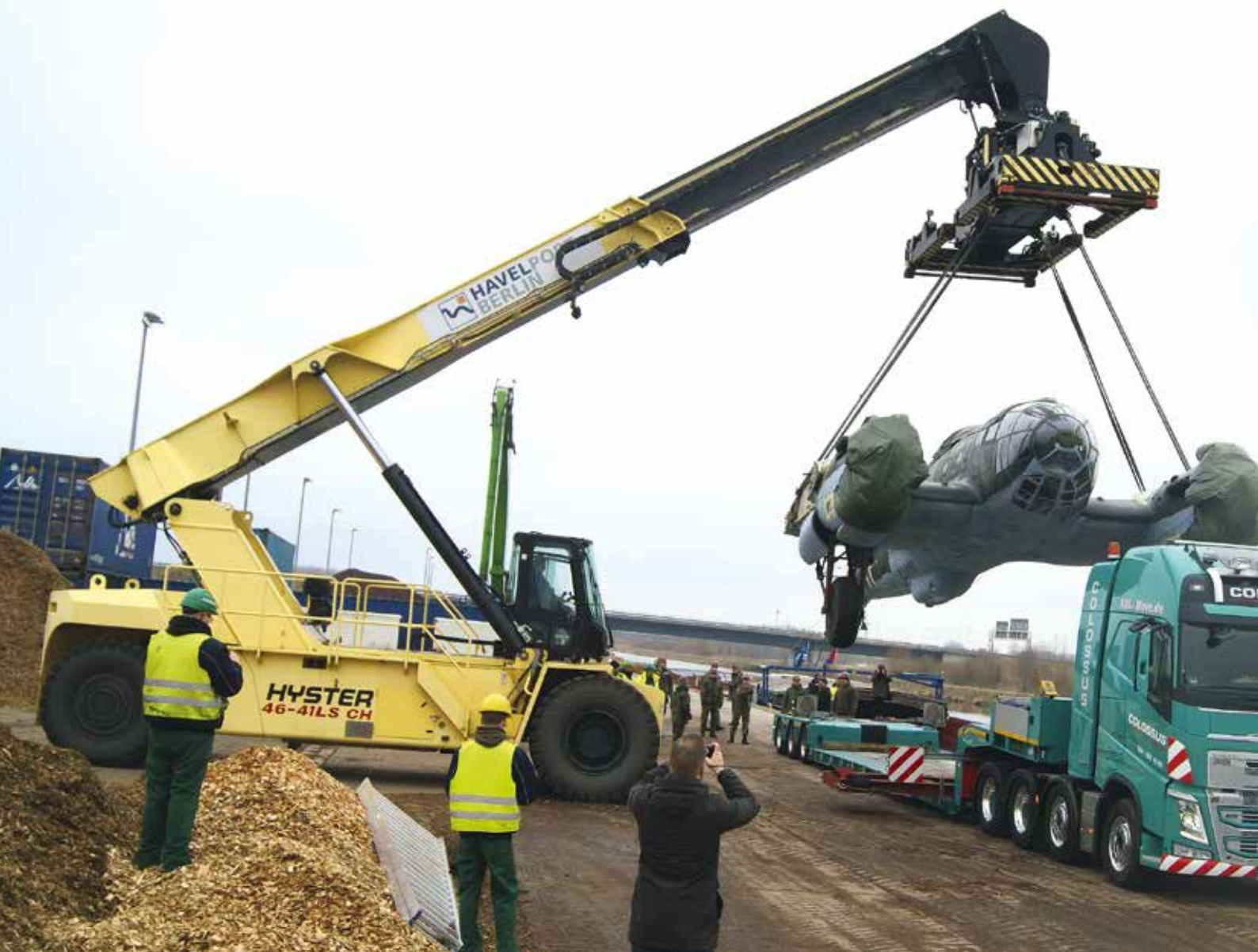
Per telekopierbaren Container-Stapler wechselt der Flugzeugrumpf vom Tieflader ...
