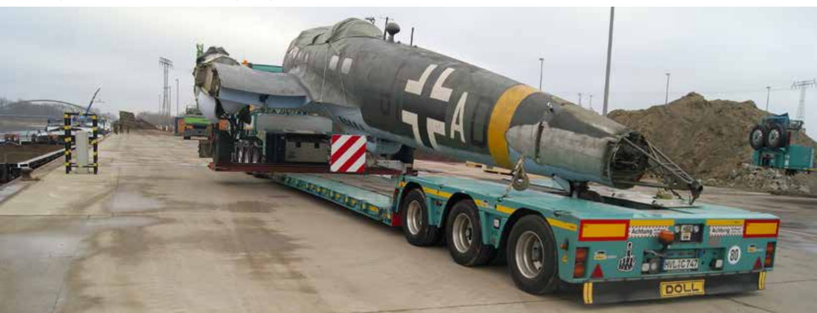
Der 6 m breite und gut 16 m lange historische Flugzeugrumpf im HavelPort Wustermark. Dieser Transport stellte keine Probleme dar. „Wir haben nur zusätzlich ein Transportgestell gebaut, damit wir das Flugzeug auf dem Tieflader richtig befestigen können“, erklärte Klaus Pietack.
