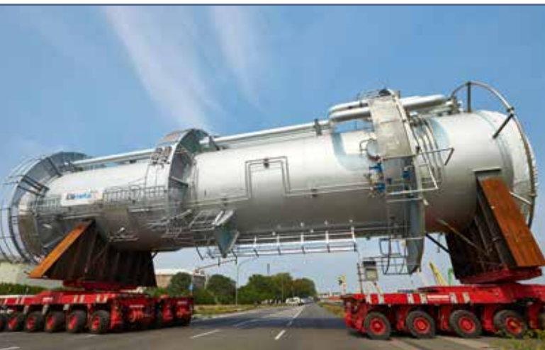
Auf der einen Seite 8 Achslinien SPMT, auf der anderen zwei quergekoppelte SPMTs mit jeweils 6 Achslinien: so ging es vom Hafen ins Werk.
