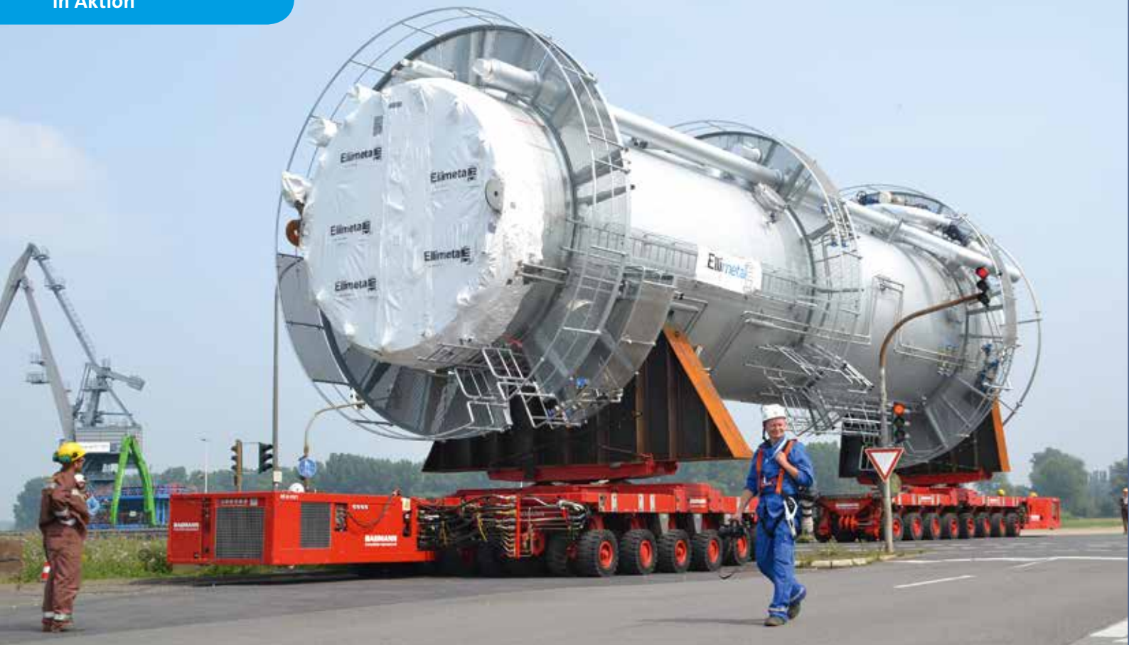
Das Mittelteil der Destillationskolonne rollt über die Bundesstraße 9.
