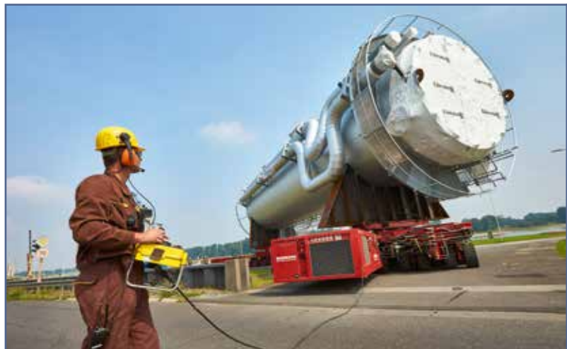
Die Last ruhte auf Drehschemeln – dies sorgte für Wendigkeit.
