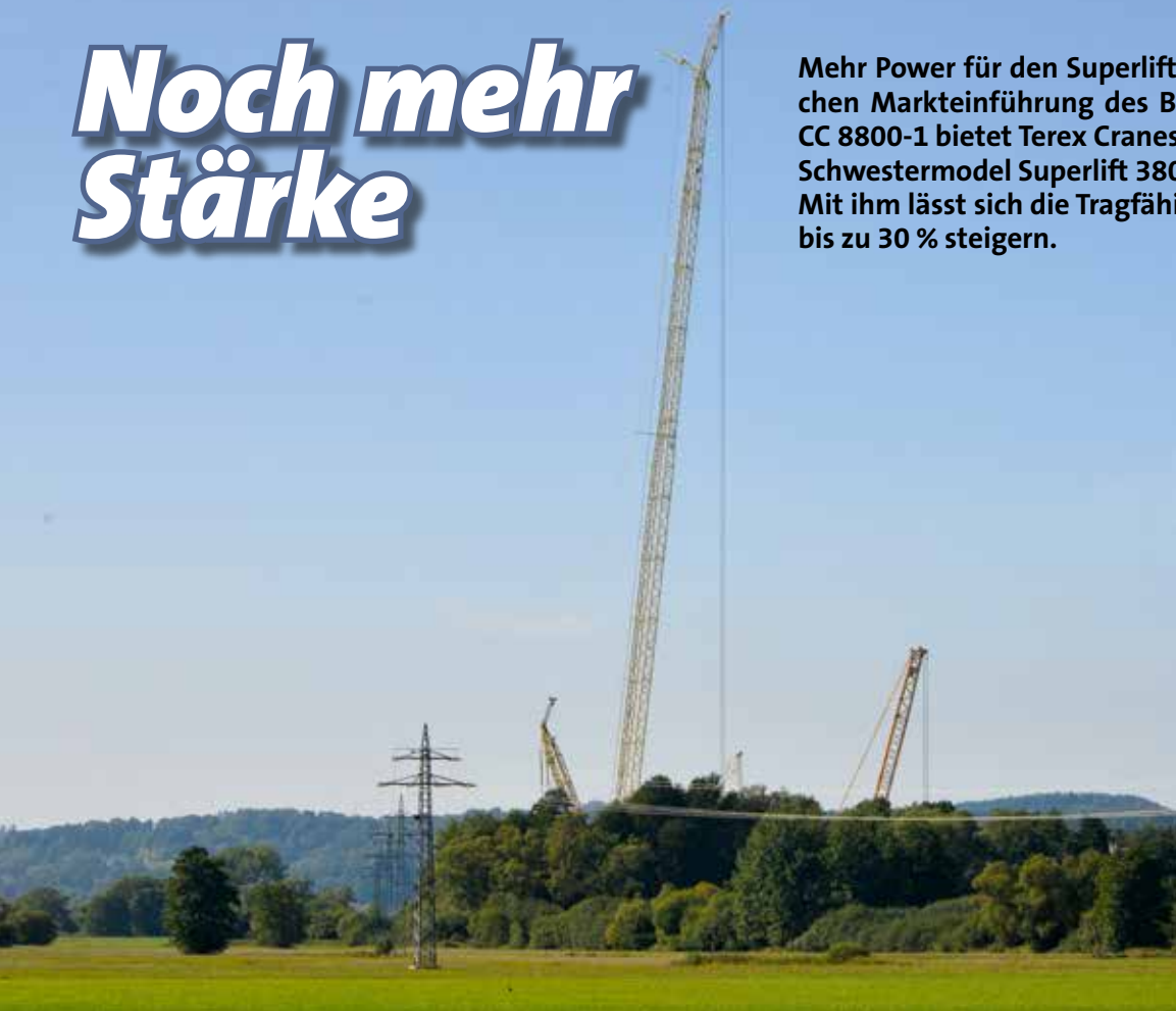
Stark hoch hinaus: Mit dem Boom Booster Kit kann der Superlift 3800 eine maximale Hakenhöhe von beeindruckenden 174 m erreichen und in dieser Konfiguration Lasten bis 80 t heben.
