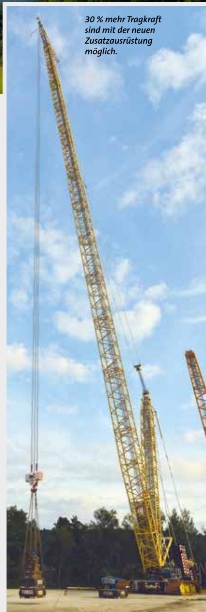
Stark hoch hinaus: Mit dem Boom Booster Kit kann der Superlift 3800 eine maximale Hakenhöhe von beeindruckenden 174 m erreichen und in dieser Konfiguration Lasten bis 80 t heben.
