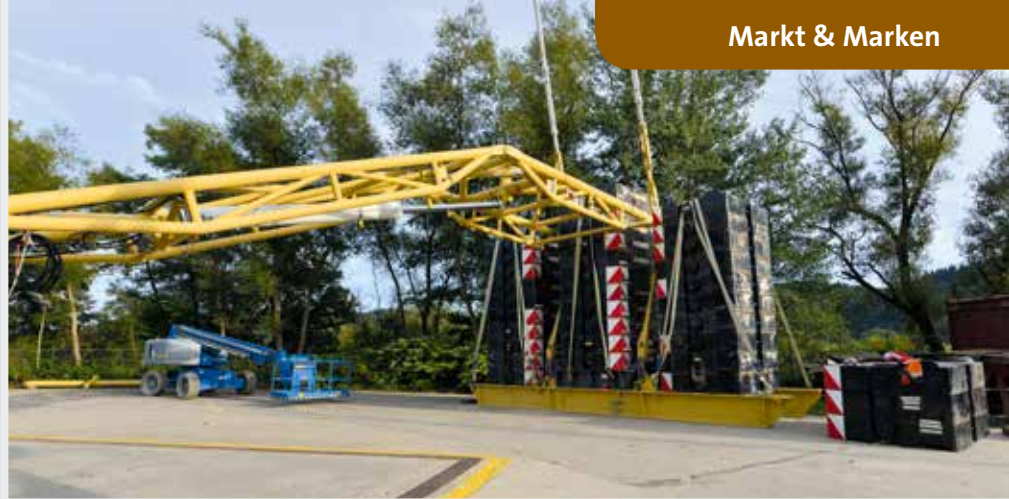
Auch für die Handhabung des Superlift-Gegengewichts hat sich Terex Neues einfallen lassen: neben dem neuen Verstellrahmen „Flex Frame“ ist auch der teilbare Superlift-Rahmen „Split Tray“ erhältlich.
