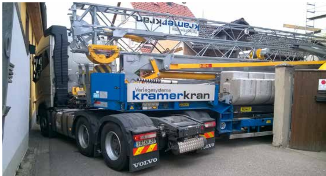
Das KramerKran-Verlegesystem kommt auch mit den geringsten Platzverhältnissen zurecht.
