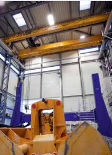
Ein Zweiträgerbrückenkrane von Konecranes ist mit einem motorgesteuerten Zweischalengreifer ausgestattet, der den Sand in die 10 Meter tiefe Versuchsgrube füllt.
