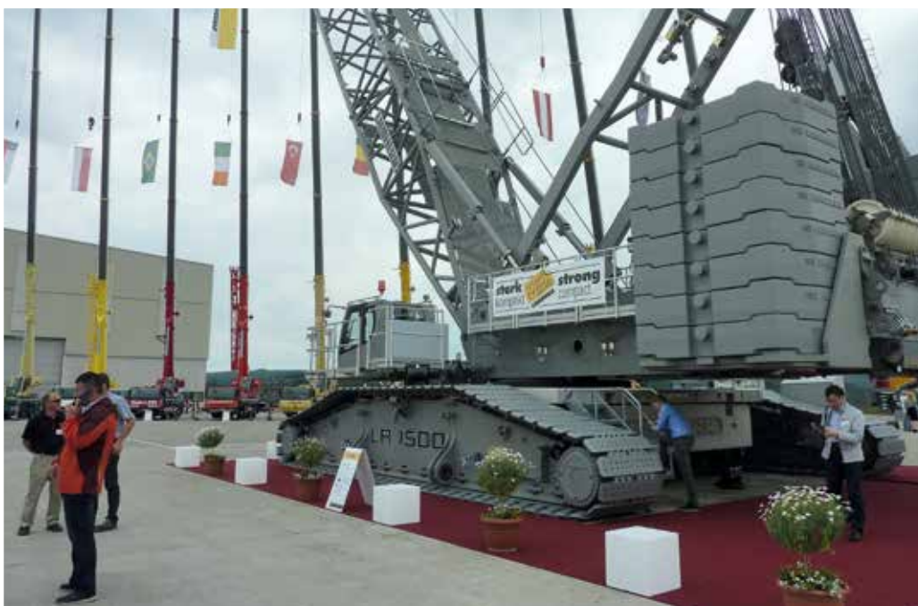
Der LR 1500 bietet die Tragkraft eines 500-Tonnners bei Komponentenabmessungen eines 400 t-Raupenkranes.
