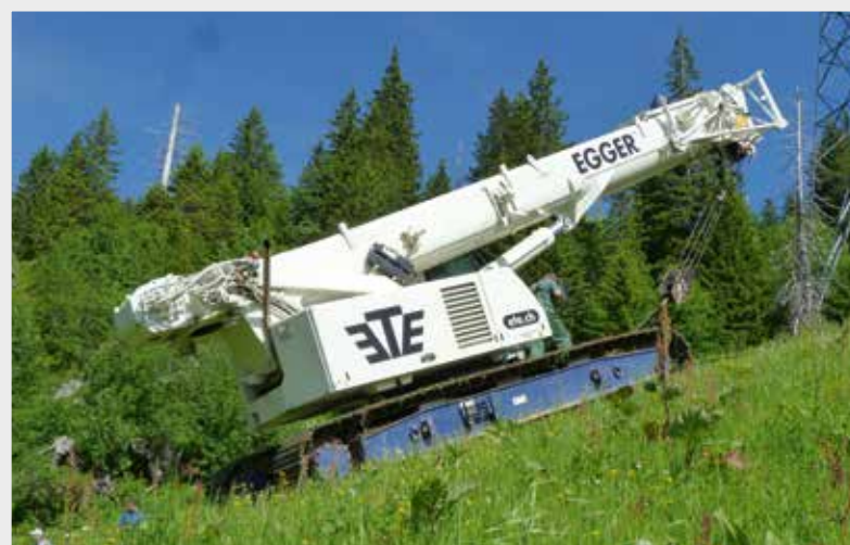
Zunächst ging es per Lkw zum Einsatzort. Die letzten 600 m über eine Wiese mit bis zu 60 % Steigung legte der Raupenkran selbstständig, aber durch eine Seilwinde gesichert, zurück.
