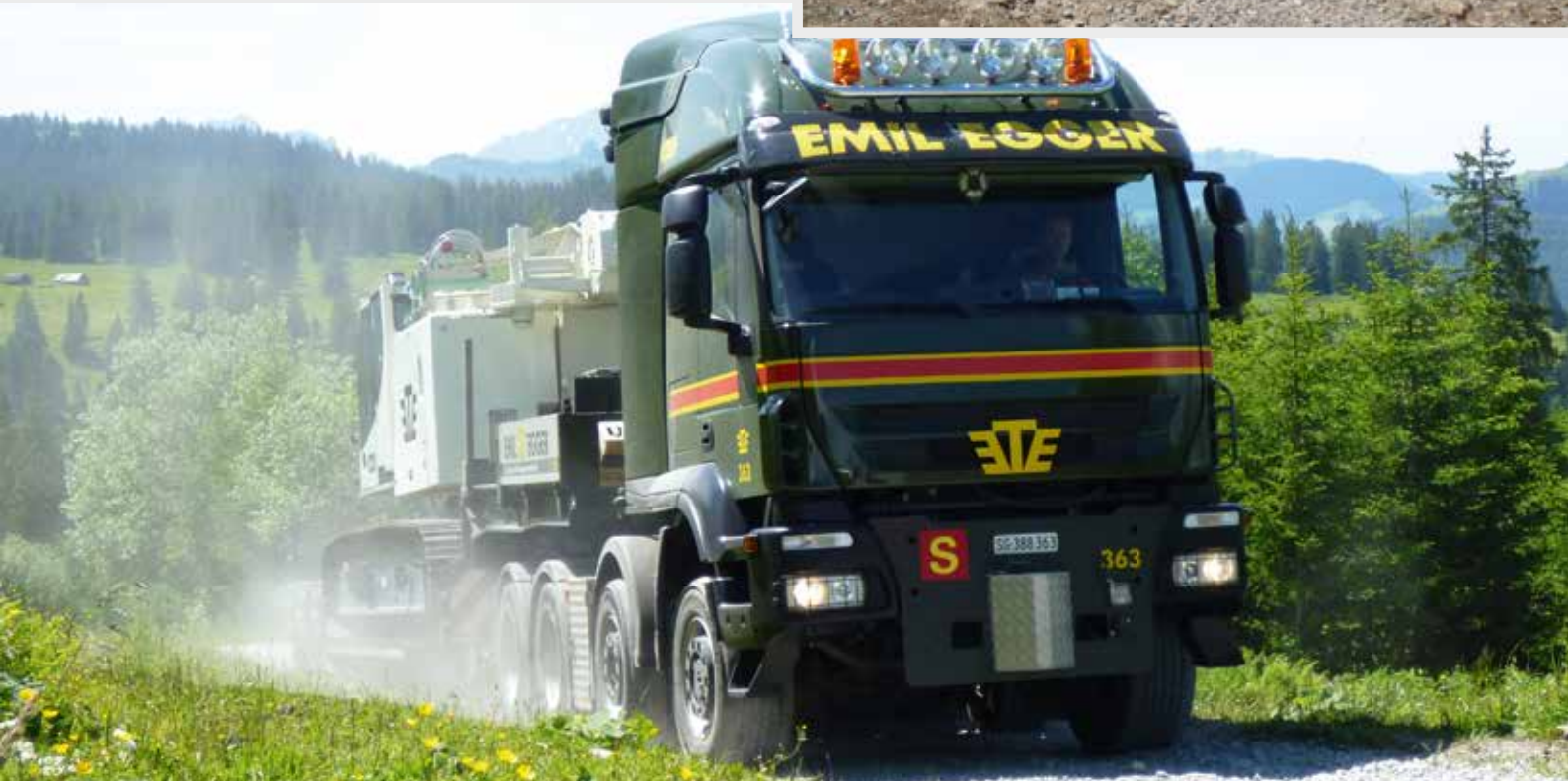
Zunächst ging es per Lkw zum Einsatzort. Die letzten 600 m über eine Wiese mit bis zu 60 % Steigung legte der Raupenkran selbstständig, aber durch eine Seilwinde gesichert, zurück.
