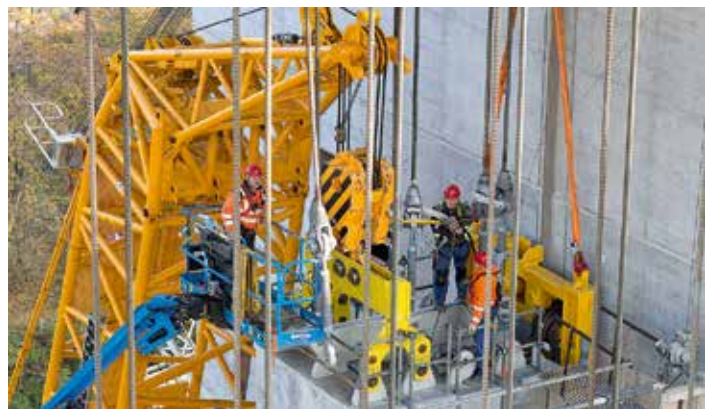
Freiraum zwischen Hakenflasche und Rollensatz: diese im Liebherr-Werk Ehingen konstruierte Mastnase wird mit maximal 6-facher Einsicherung betrieben – der Seilfestpunkt liegt direkt über dem Rollensatz.
