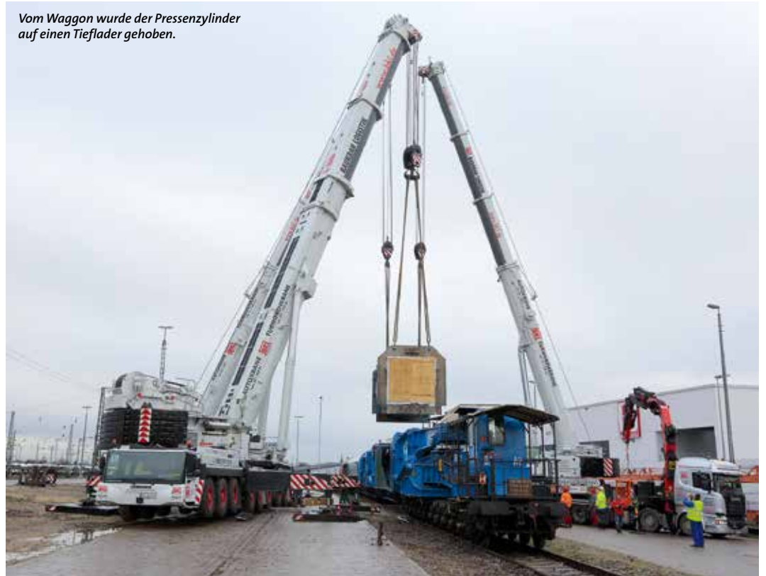
Zwei Liebherr LTM 1200-5.1 und ein LTM 1500-8.1 heben gemeinsam den 220 t schweren Pressenzylinder.
