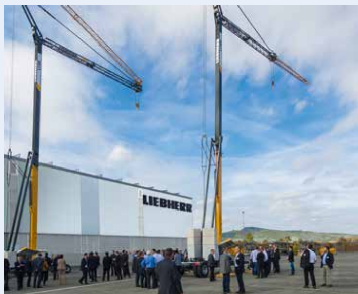
Mit lediglich 1,9 m Drehradius ist der neue hydraulische Schnelleinsatzkran L1-24 äußerst anpassungsfähig bei beengten Platzverhältnissen. Dank der flexiblen Abstützbasis lässt sich die Standfläche auf unter 4 m verringern. Straßensperren können so oftmals umgangen werden.
