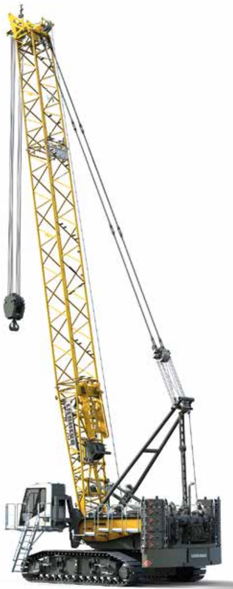
Die Positionierung der Fahrerkabine des neuen LR 1100 in einer Höhe von 2,3 m ermöglicht dem Geräteführer einen besten Überblick über die gesamte Baustelle.
