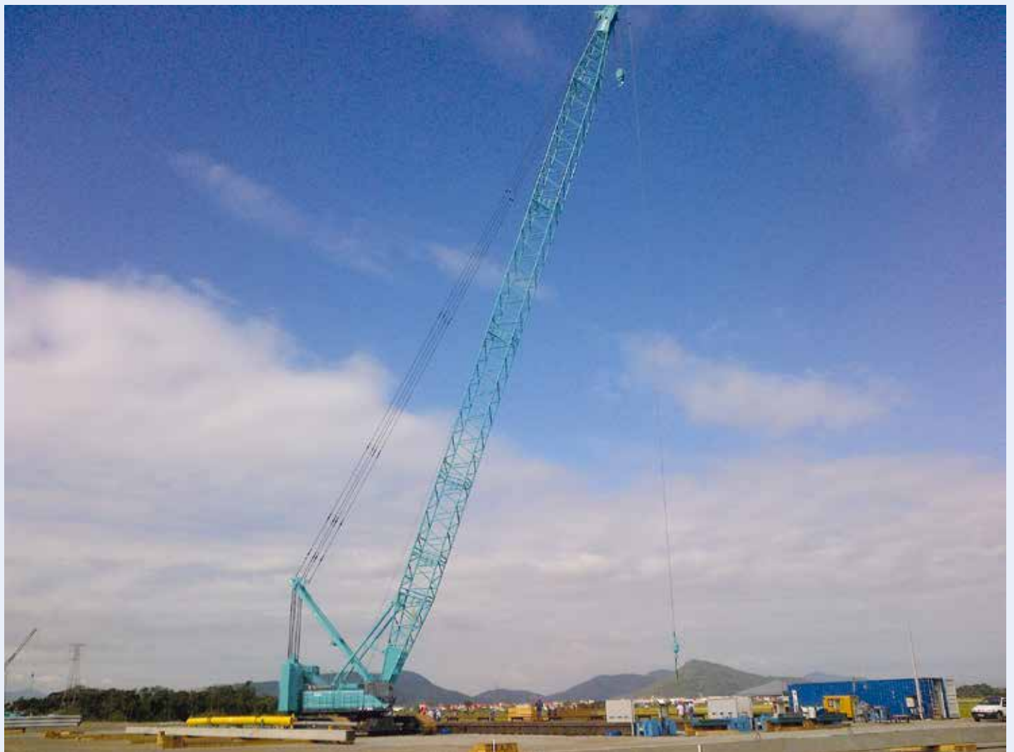
KM Mit dem CKE2500G zeigt Kobelco in München seinen Gittermastraupenkrane mit einer Tragkraft von bis zu 250 t.
