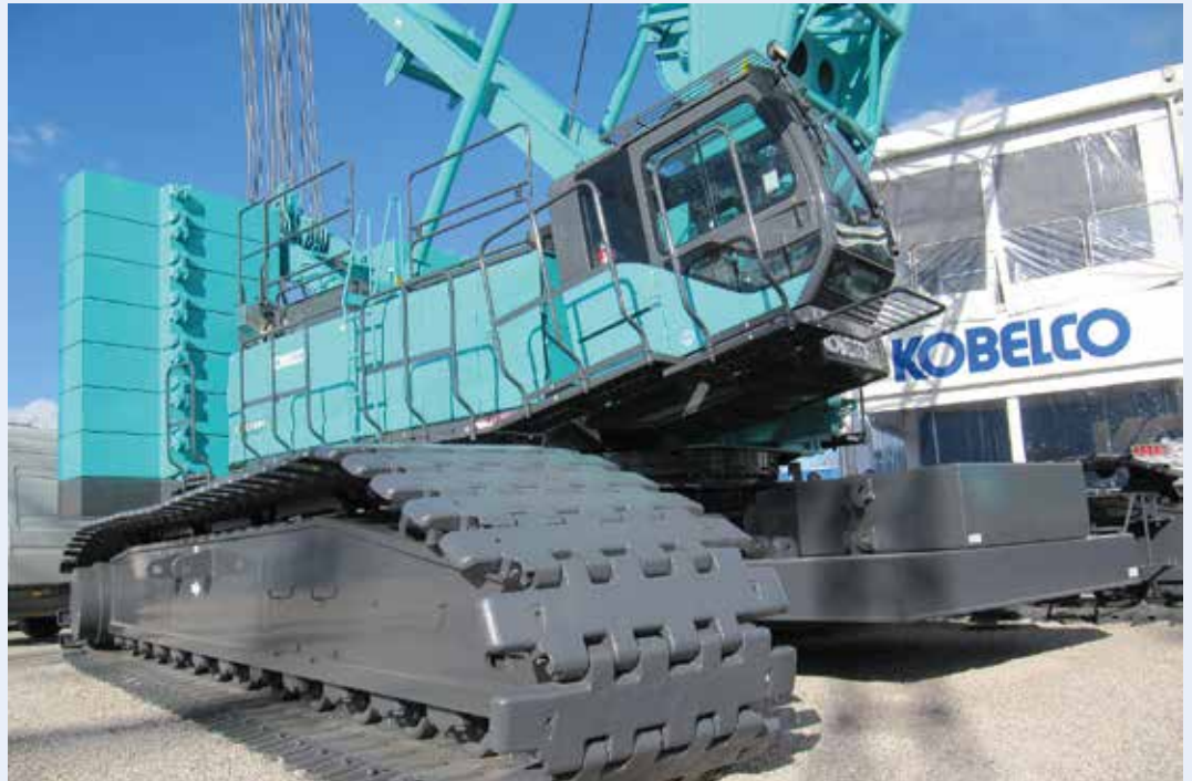
KM Mit dem CKE2500G zeigt Kobelco in München seinen Gittermastraupenkrane mit einer Tragkraft von bis zu 250 t.
