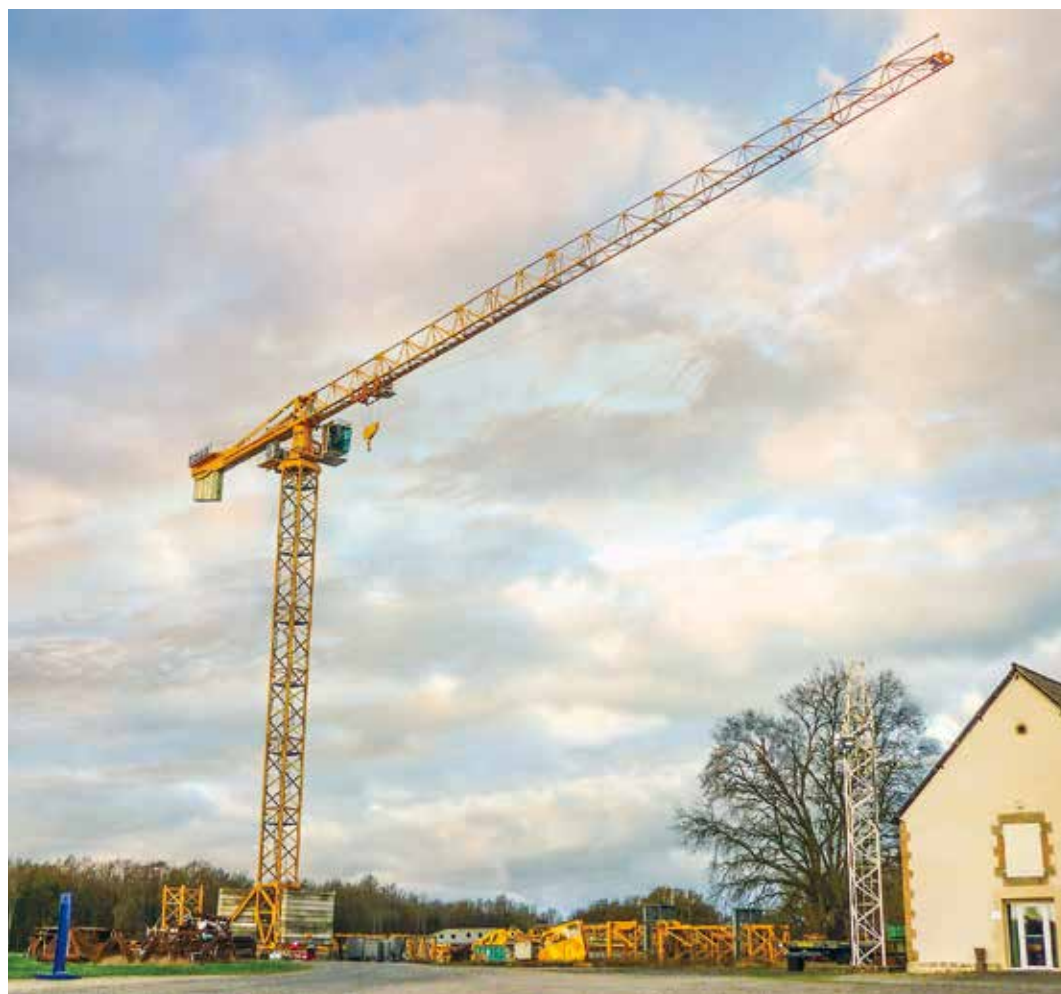
Der MDT 389 ist der größte einer neuen Reihe von Topless-Kranen von Potain, die allesamt mit dem Maniwoc-Kransteuerungssystem (CCS) ausgerüstet sind.
