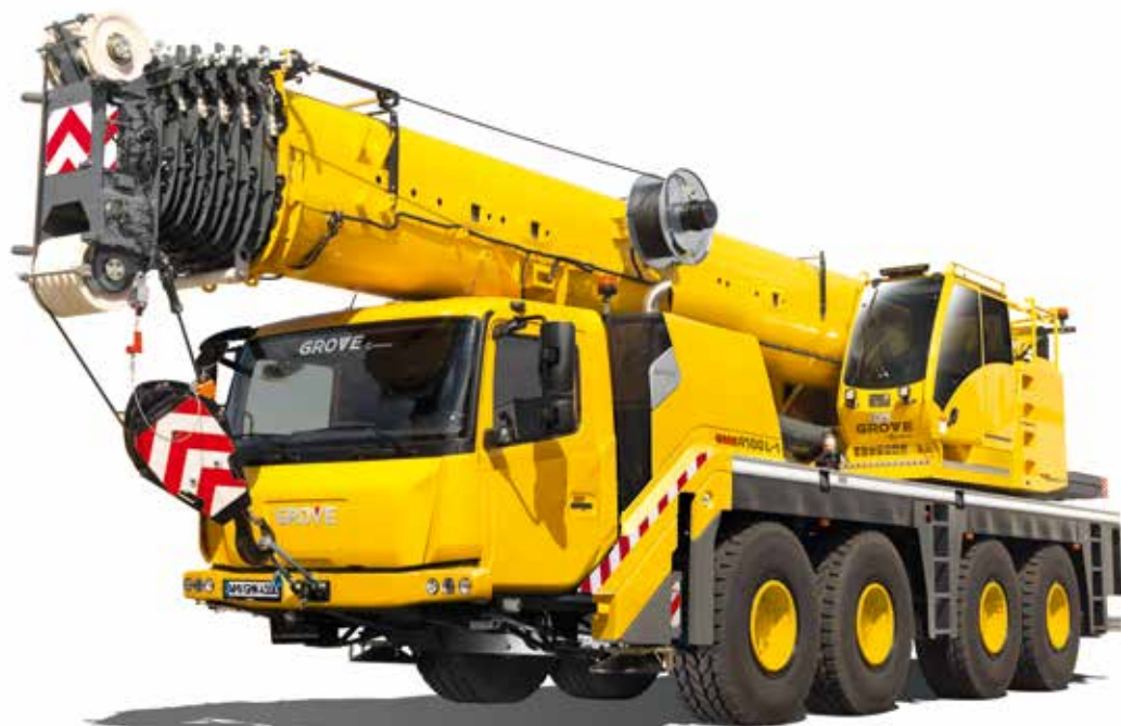
Schlanker als sein Vorgänger: der GMK4100L-1 hat mit nur noch 2,55 m breite Lkw-Maße.
