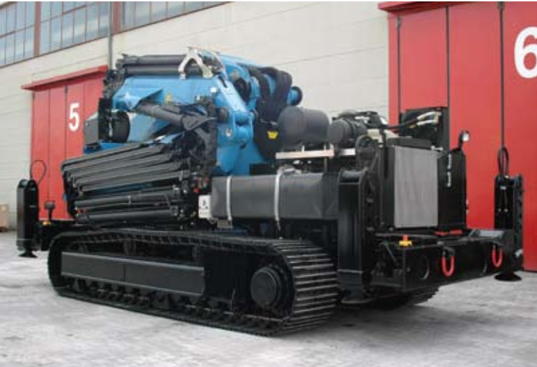
Die Raupenfahrtschiffe werden ja nach Krangröße ausgeführt und modifiziert. Bei einem 120 mt-Ladekran werden Raupenfahrtschiffe der Baugröße D6 verwendet.
