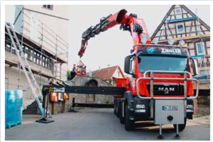
Einseitig abgestützt: der Palfinger PK 150002 Performance.
