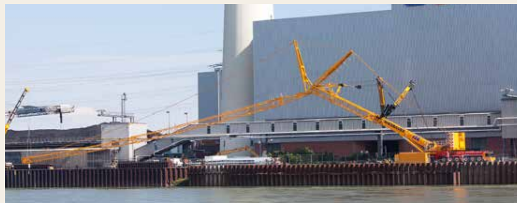
Gleich ist es soweit: Der LTM 1750-9.1 kurz vor dem Aufrichten in vollem Rüstzustand.
