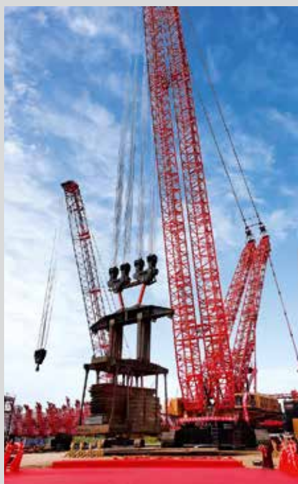
Das Bild zeigt den Sany SCC40000A bei seiner Präsentation auf einem herkömmlichen Raupenfahrwerk.
