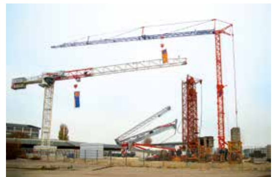
Unter anderem waren auf bei der R&L Kranservice in Langenau ein Arcomet A45 Eco sowie ein Terex Comedil CTT 132-6 ausgestellt.
