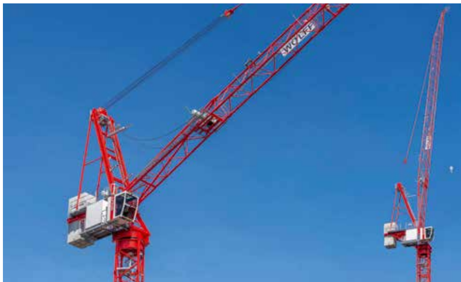
Der neue Wolff 235 B bietet eine maximale Tragfähigkeit von 8 t im 1-Strang-Betrieb und 16 t im 2-Strang-Betrieb, sowie Auslegerlängen von 30 bis 60 m.
