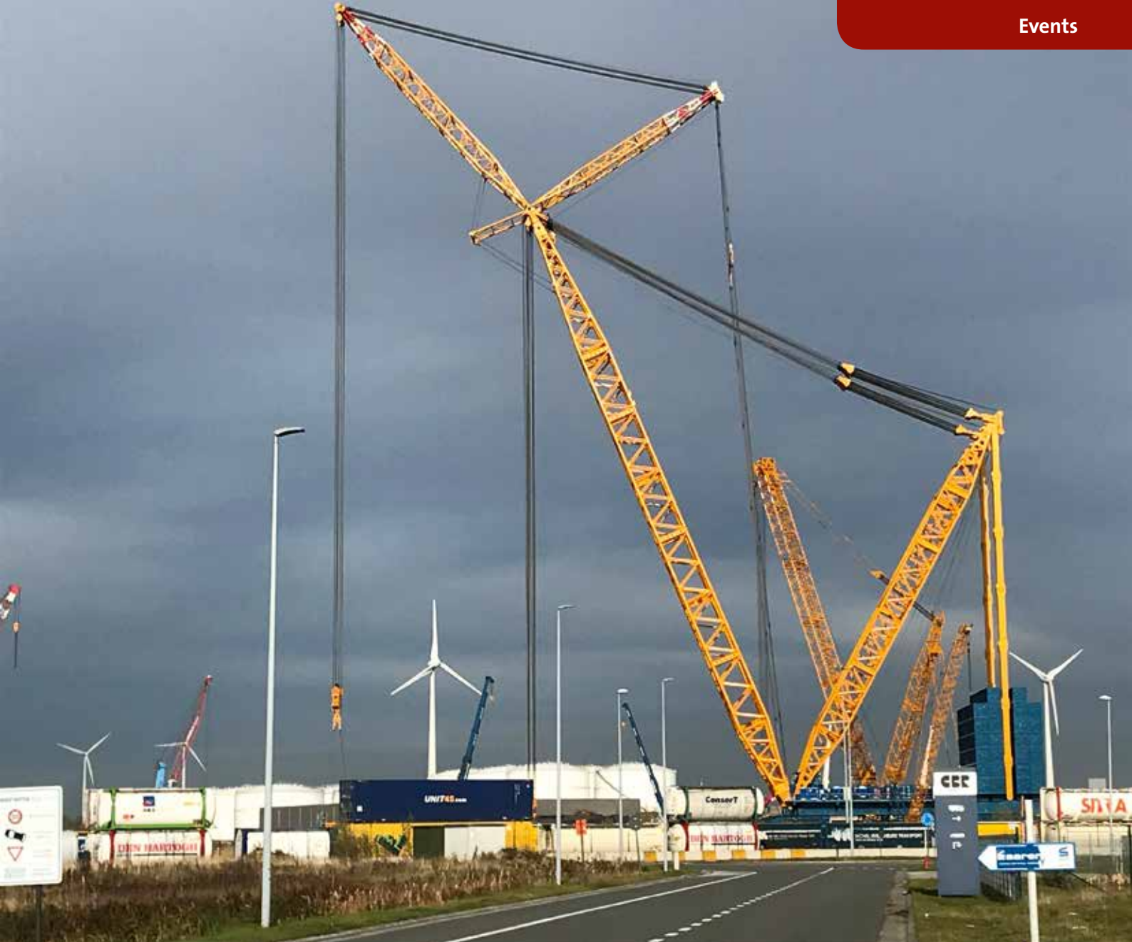
Vorübergehendes Wahrzeichen im Hafengelände von Gent: der SGC-250 bei seiner Präsentation am 9. November 2018 mit 118 m langem Hauptausleger plus 52,3 m Wippspitze.
