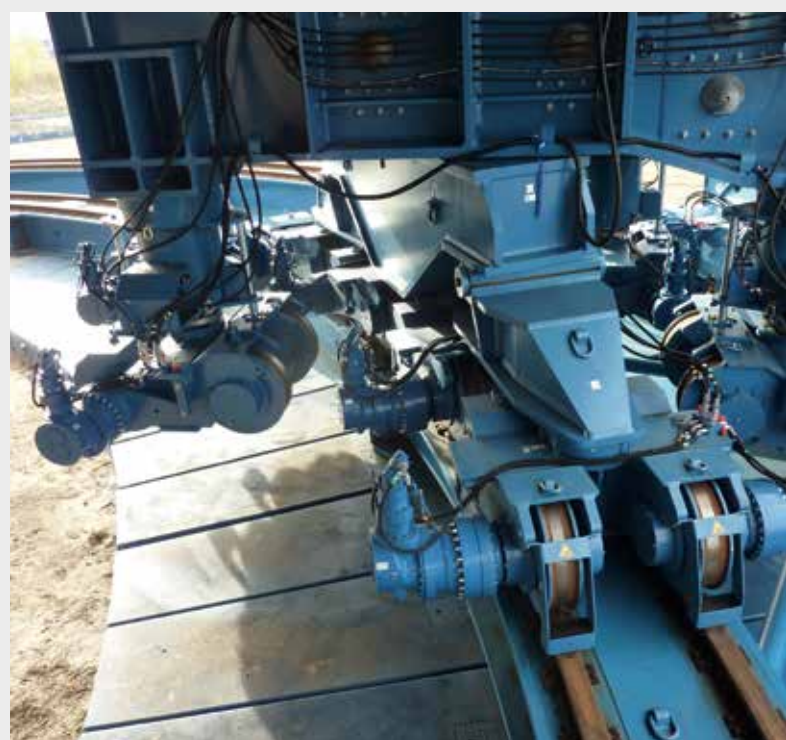
Während des Hub-Einsatzes bewegt sich der Kran dank 128 Rädern auf den Schienen des Ringes. Soll der SGC-250 an eine andere Hubposition gelangen, so stehen für das Verfahren auf Schienen 96 eigens dafür gedachte Räder zur Verfügung. Per Hydraulik werden sie ausgefahren und setzen dann auf die Schienen zum Verfahren auf.
