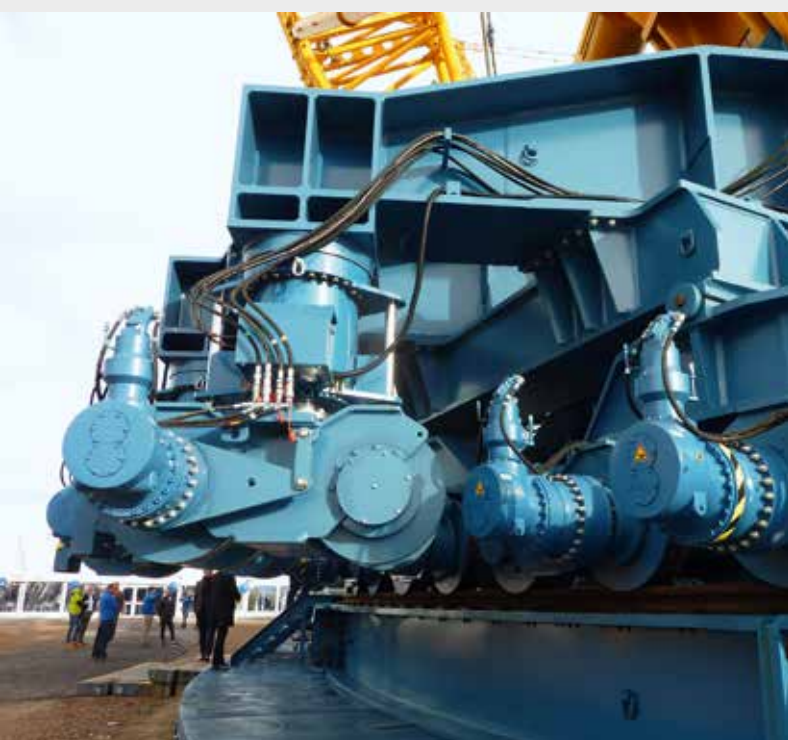
Während des Hub-Einsatzes bewegt sich der Kran dank 128 Rädern auf den Schienen des Ringes. Soll der SGC-250 an eine andere Hubposition gelangen, so stehen für das Verfahren auf Schienen 96 eigens dafür gedachte Räder zur Verfügung. Per Hydraulik werden sie ausgefahren und setzen dann auf die Schienen zum Verfahren auf.
