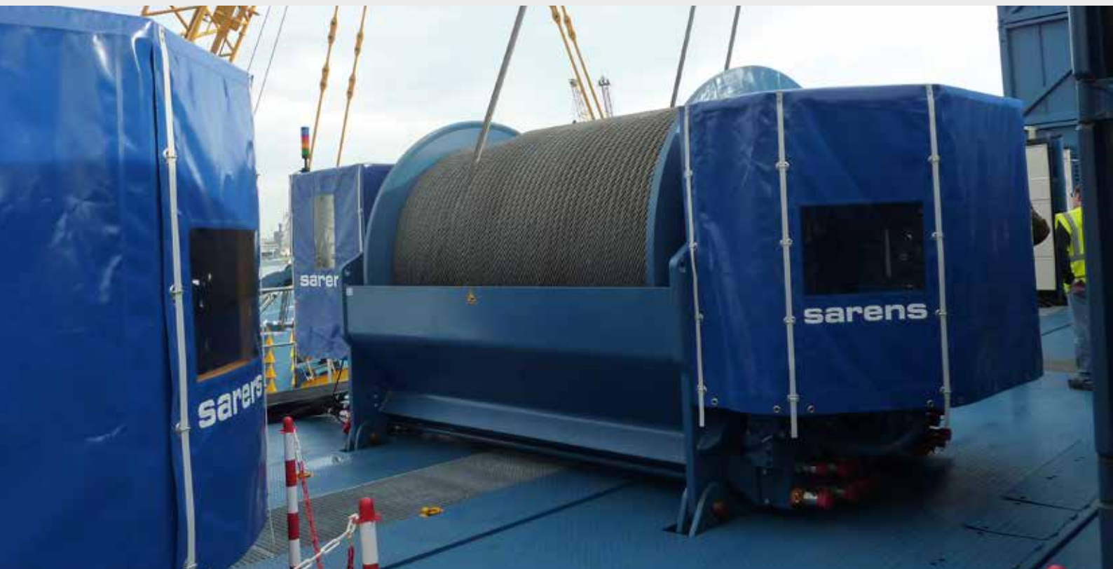
Der SGC-250 ist mit zehn Winden ausgerüstet.
