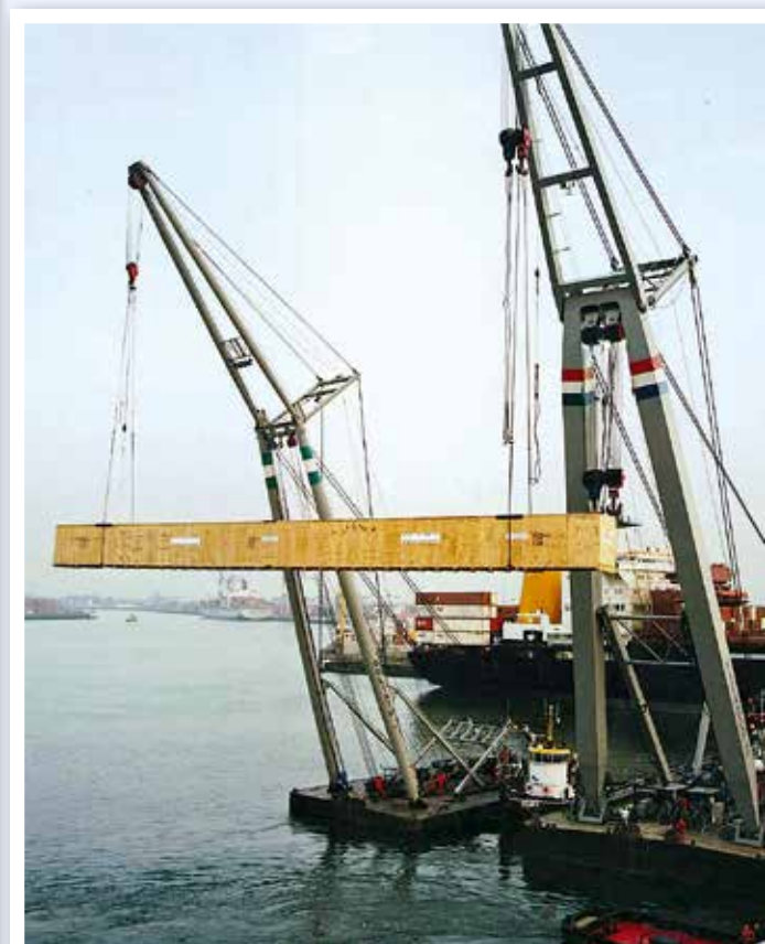
Für die Verladung dieser überlangen Holzkiste müssen schon zwei Krane im Tandem ran. Foto: HPE
