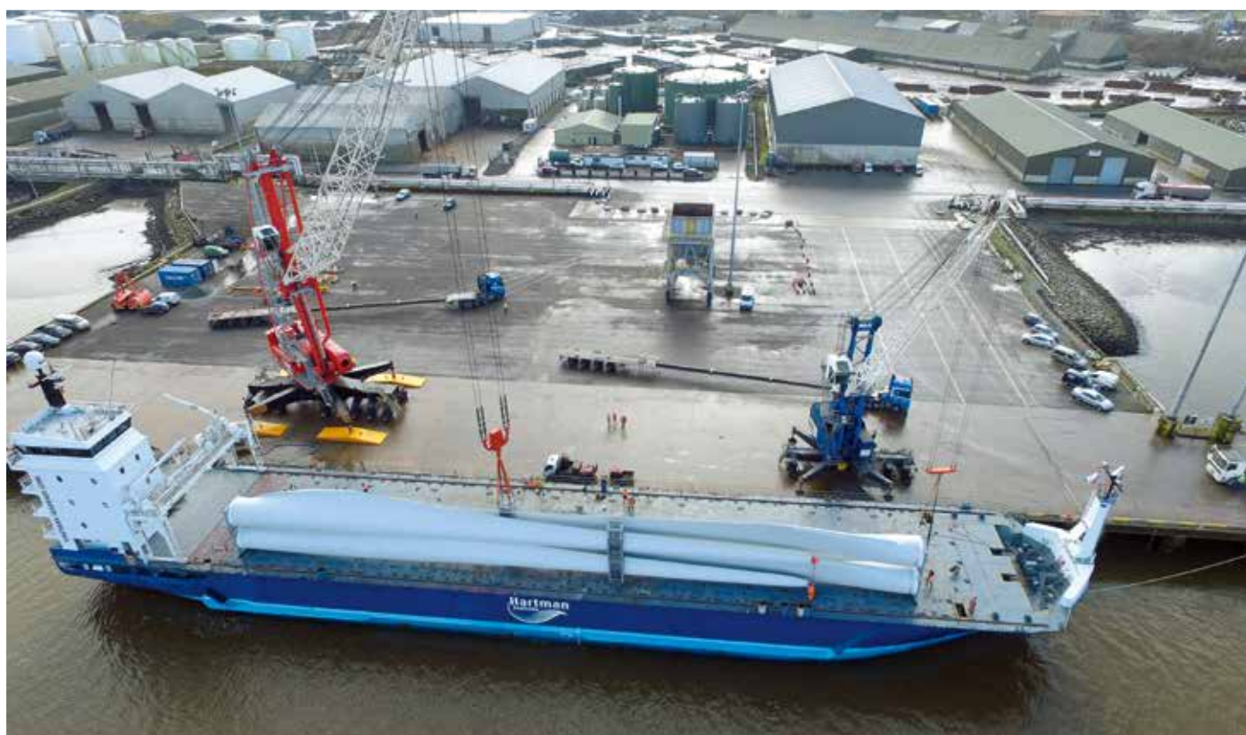
Direkt vom Liebherr-Werk Rostock zum Einsatz im irischen Foynes: der Liebherr-Hafenmobilkran LHM 420.
