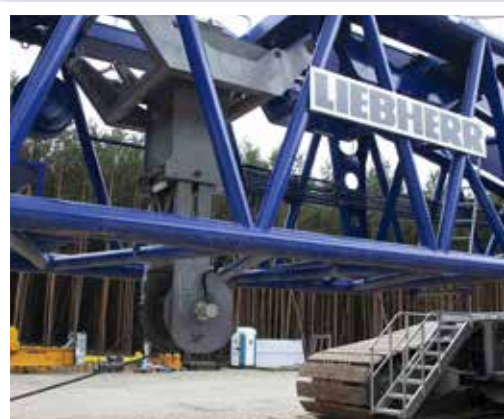
Nachrüstbar: Die Spannwinde ist anstelle der Wippspitzen-Verstellwinde eingebaut.
